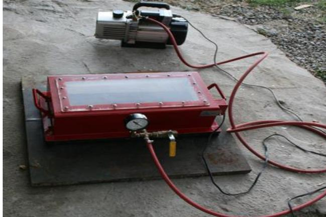
Figura 1.9 Inspección de junta soldada por cámara de vacío
