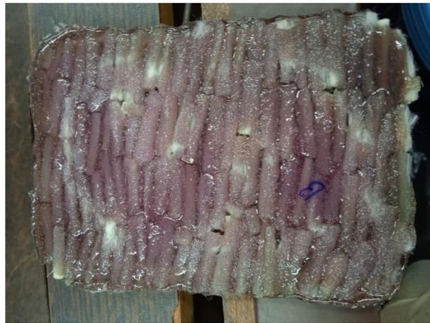
Figura 2.12. Resultado de material compuesto con filtros de cigarrillo (lado B).
