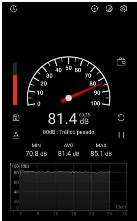
Figura 3.24. Prueba acústica 1 sin aislamiento.
