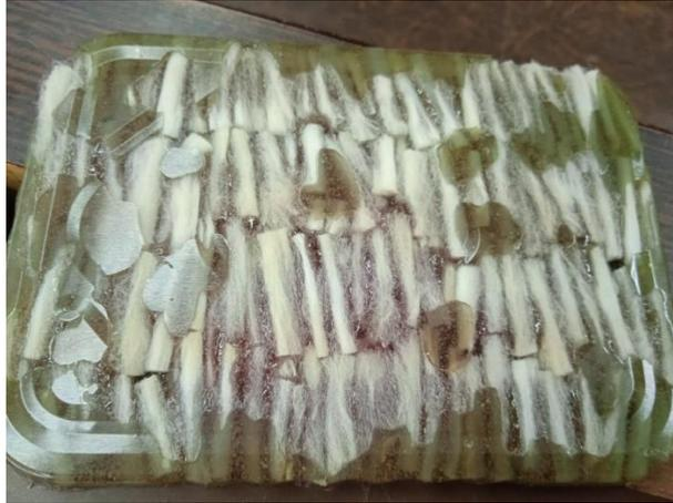
Figura 2.11. Resultado de material compuesto con filtros de cigarrillo (lado A).
