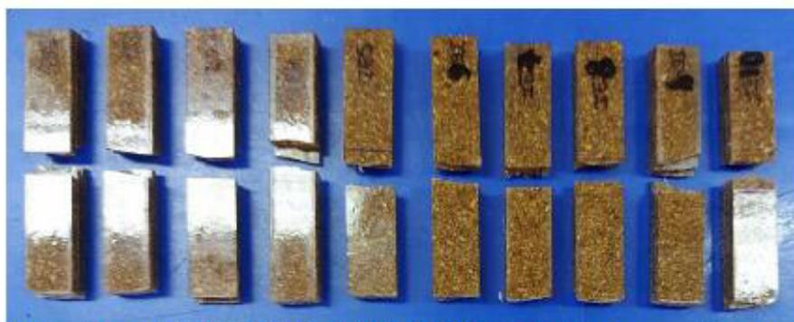
**Figura 4.** Probetas del grupo "IE" (MI-21-0728 a la MI-21-0737) después de los ensayos de impacto por péndulo.
