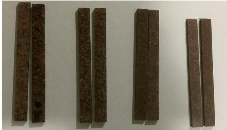
Figura 2.37. Probetas para ensayo de flexión de izquierda a derecha (B, C, D y E).
