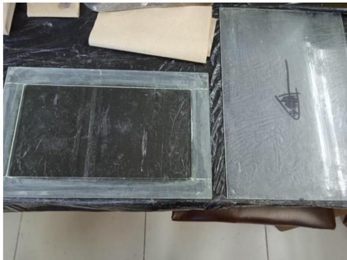
Figura 2.31. Molde de vidrio con cera desmoldante limpia en la base.
