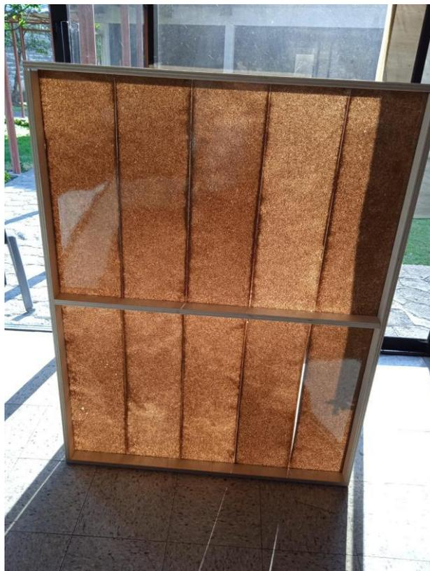
Figura 3.40. Armazón de madera con planchas del material compuesto.
