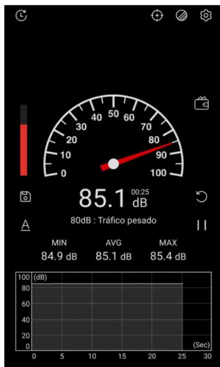
Figura 3.26. Prueba acústica 3 sin aislamiento.
