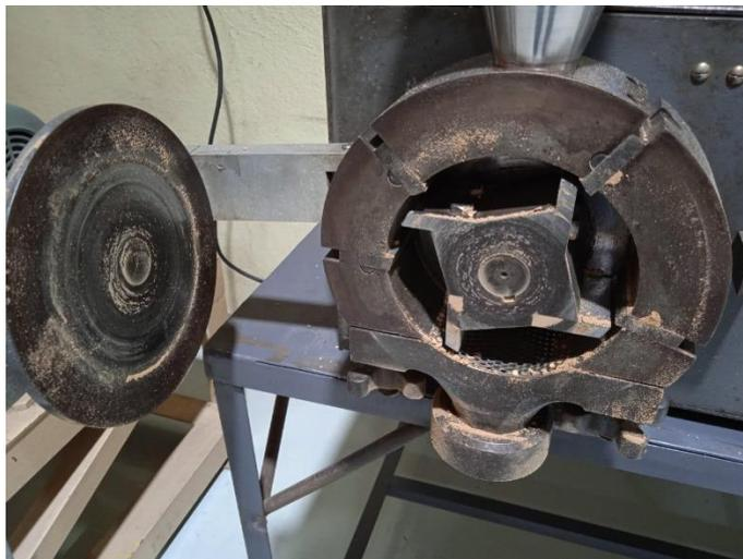
Figura 2.19. Interior de molino de cuchillas.
