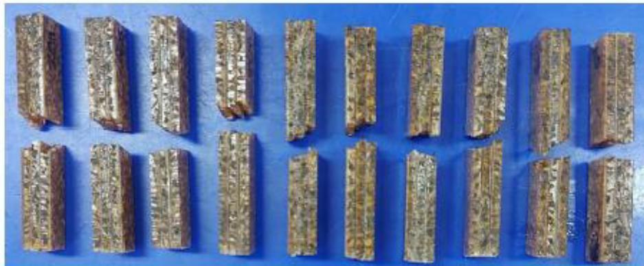
**Figura 2.** Probetas del grupo "IC" (MI-21-0708 a la MI-21-0717) después de los ensayos de impacto por péndulo.
