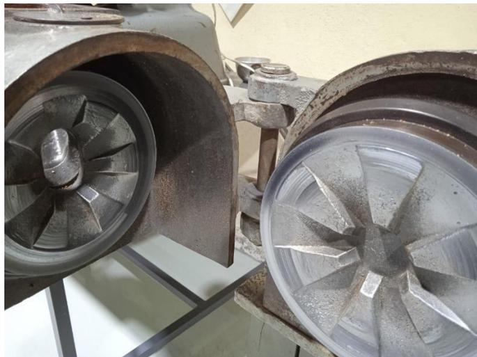
Figura 2.15. Interior de molino de discos.
