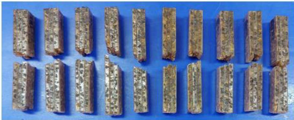
**Figura 1.** Probetas del grupo "IB" (MI-21-0698 a la MI-21-0707) después de los ensayos de impacto por péndulo.
