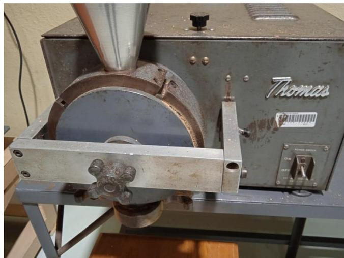
Figura 2.17. Molino de cuchillas.
