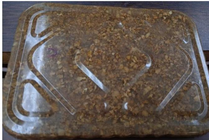
Figura 2.27. Tercer intento de material compuesto, material compuesto obtenido correctamente.
