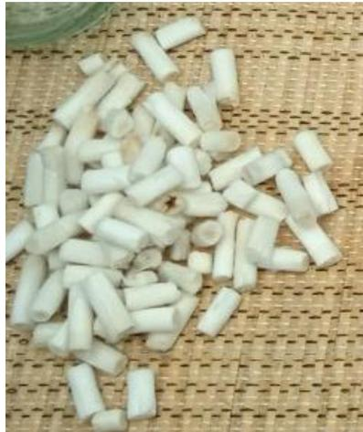
Figura 2.10. Filtros de cigarrillo descontaminados listos para ser utilizados como refuerzo.
