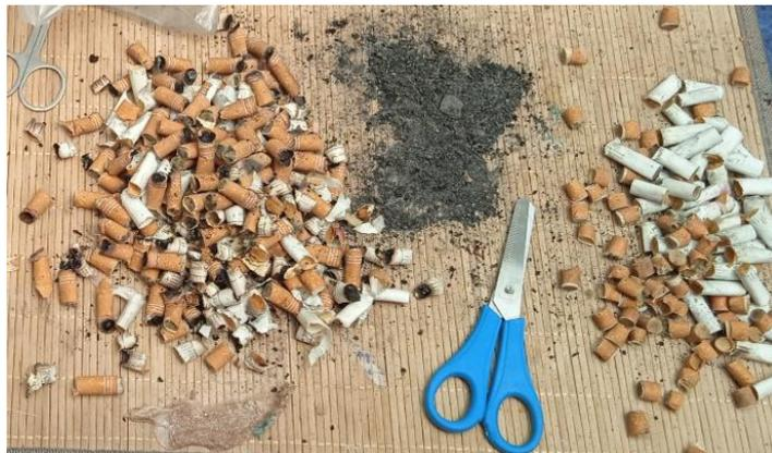
Figura 2.6. Proceso de corte y separación de sobrante de cigarrillo del filtro.
