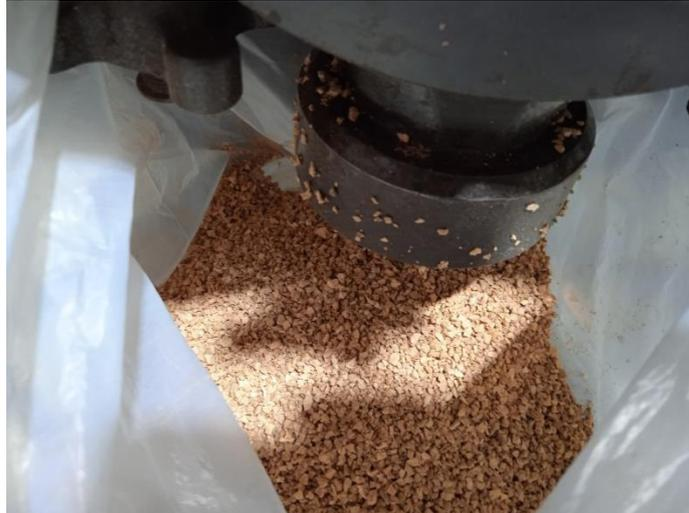
Figura 2.20. Resultado de corcho triturado por molino de cuchillas.
