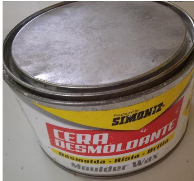
Figura 2.28. Cera desmoldante utilizada.
