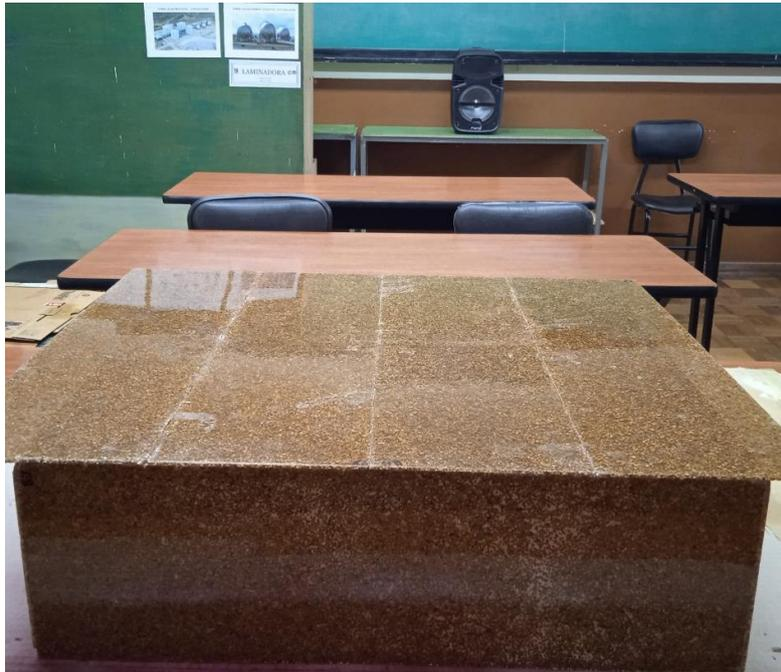
Figura 2.42. Fuente de sonido (parlante) y caja de material compuesto.
