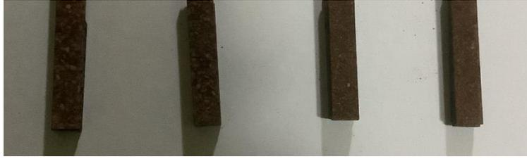
Figura 2.39. Probetas para ensayo de impacto de izquierda a derecha (B, C, D y E).
