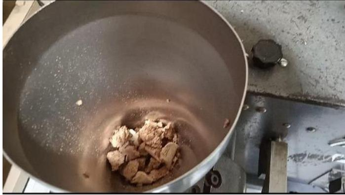
Figura 2.18. Garganta de alimentación de molino de cuchillas.
