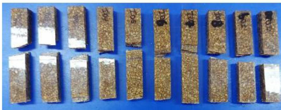
**Figura 3.** Probetas del grupo "ID" (MI-21-0718 a la MI-21-0727) después de los ensayos de impacto por péndulo.
