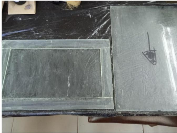
Figura 2.30. Molde de vidrio con cera desmoldante.
