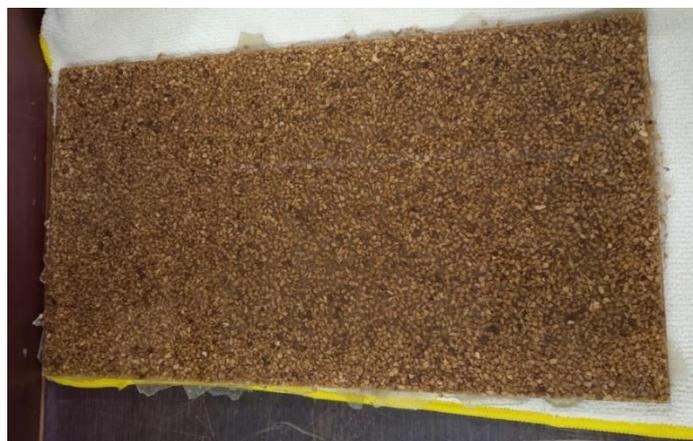
Figura 2.33. Material compuesto desmoldado en proceso de curación.
