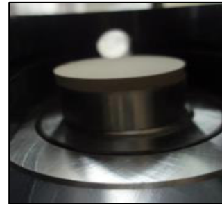
f) Núcleo del troquel desmontado con la pastilla o "press" pellet
