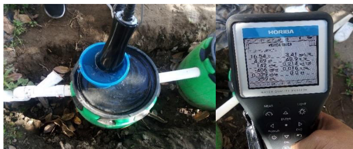
Figura 7. Medición de pH y Temperatura in situ del afluente
