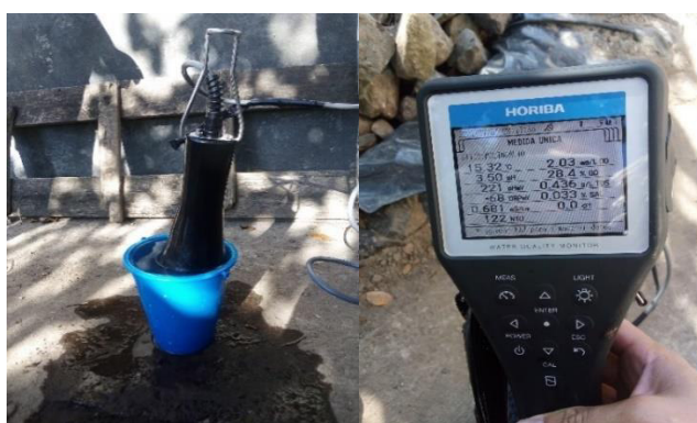
Figura 40. Medición de pH y Temperatura in situ del efluente
