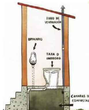
Figura 2. Cámara simple mejorada ventilada (BIM, 2018)
