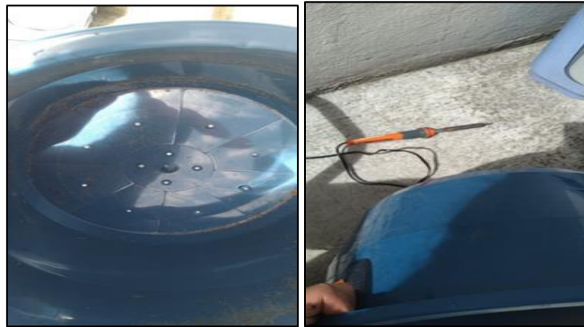
Figura 16. Perforación de las tinas.
