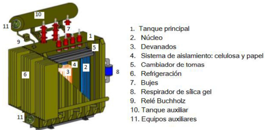
Figura 2.11 Componentes de un transformador de potencia [10].
