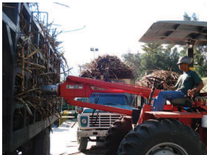
Figura 7. Muestreo de la caña de azúcar con la ayuda de la sonda horizontal
