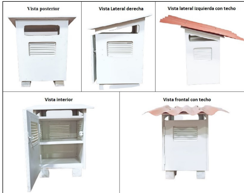
Figura 3. 2. Garita meteorológica terminada.
