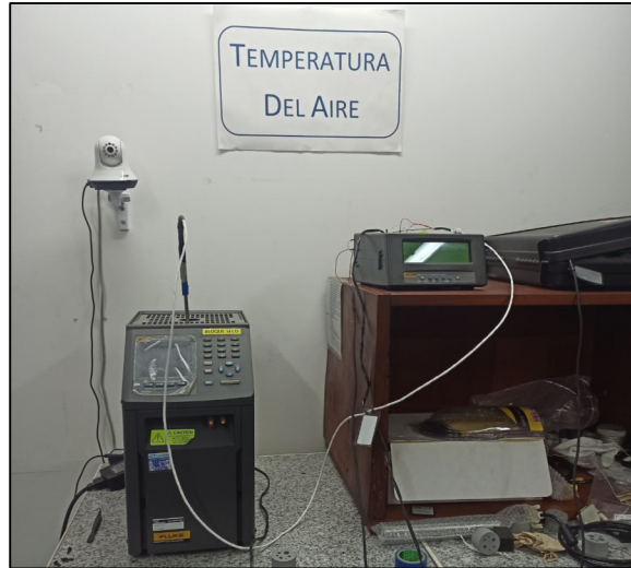
Figura 3.26. Bloque seco FLUKE.
