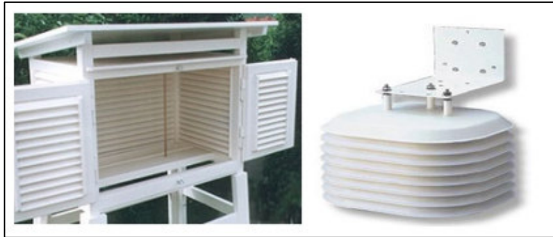
Figura 1. 5. Garitas de madera y plástico con ventilación natural [37] [38].
