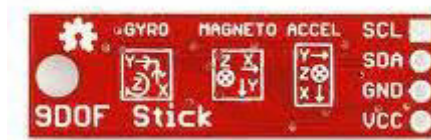
Figura 1.5 IMU 9 grados de libertad.
