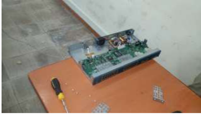
Figura 3.22 Limpieza de componentes de rack
