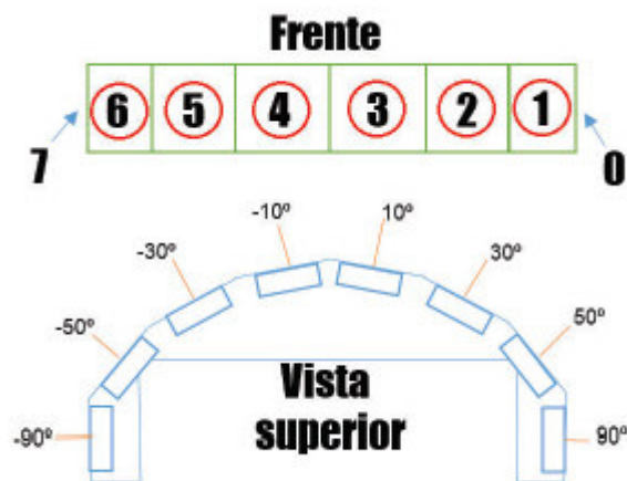
Figura 2.13. Disposición de los sensores al frente del robot Pioneer 3-DX [5].
