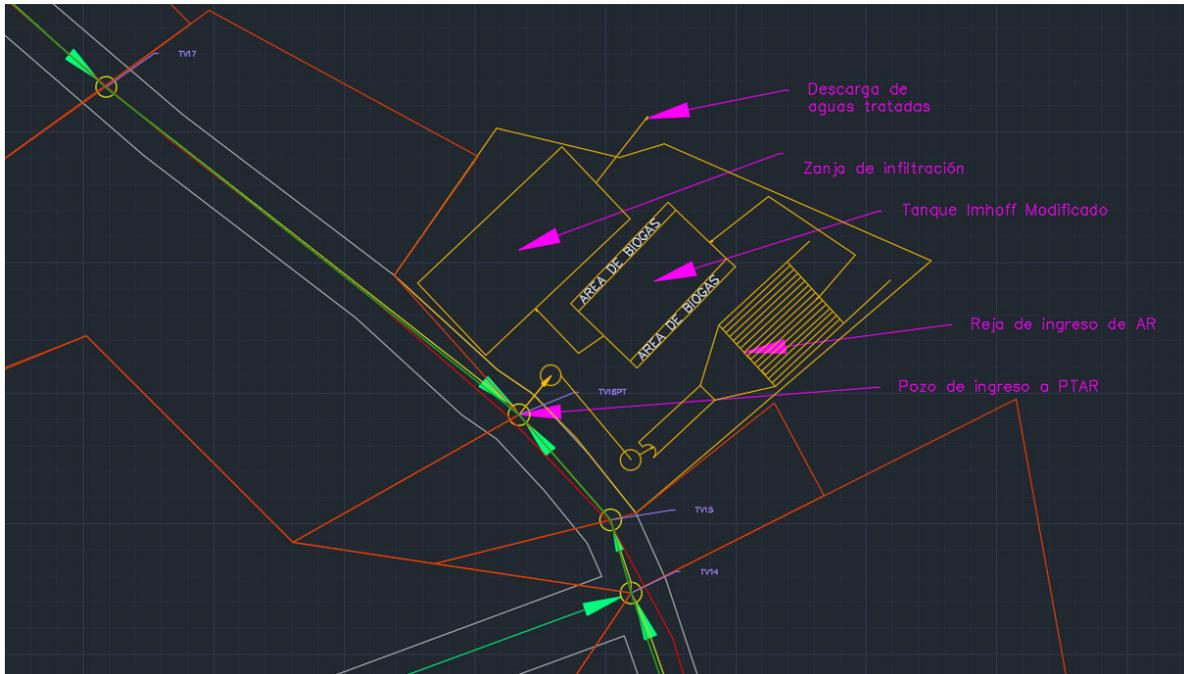
Figura 22: Áreas de afluencia (rojo), dirección de flujo (verde), Colector Principal y PTAR (amarillo), etiquetado de pozos (lila).
