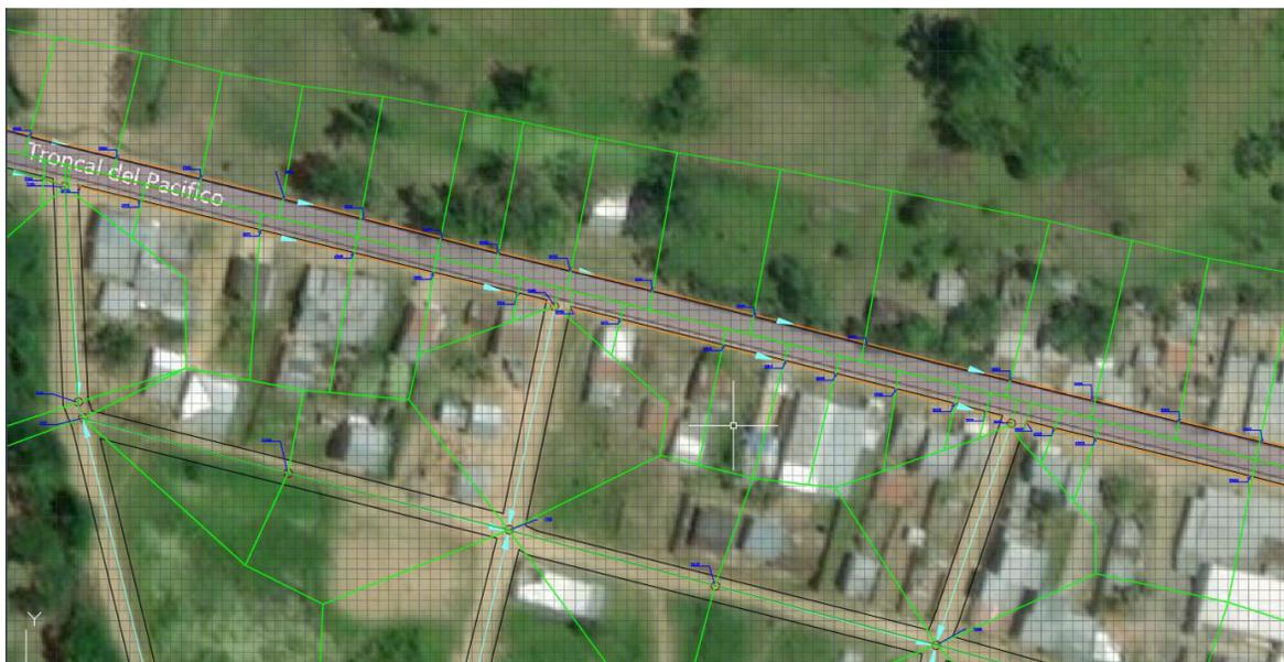
Figura 10: Ubicación de los colectores terciarios a lo largo de la carretera Troncal del Pacifico, con sus respectivas áreas de afluencia.
