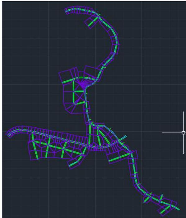
Figura 26: Diseño de la red de alcantarillado pluvial, áreas de aporte: morado, cunetas: verde, calles: celeste.
