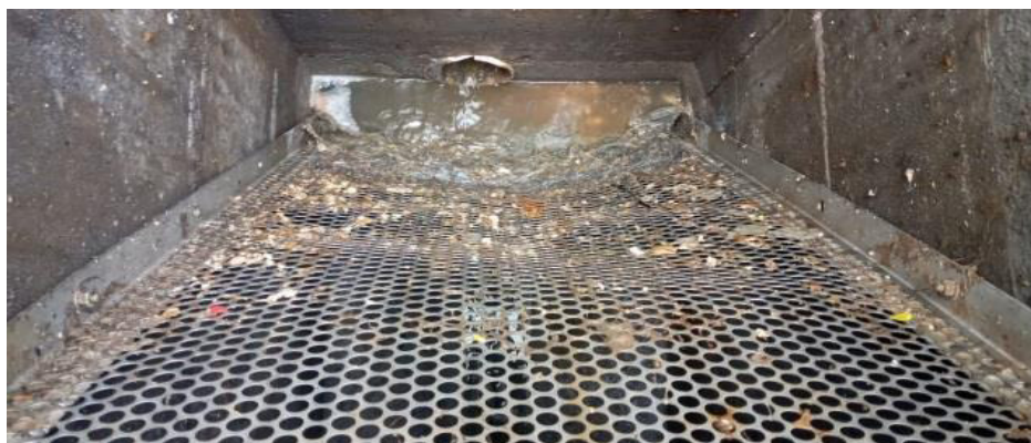
Figura 4 Tamiz de separación de sólidos gruesos
