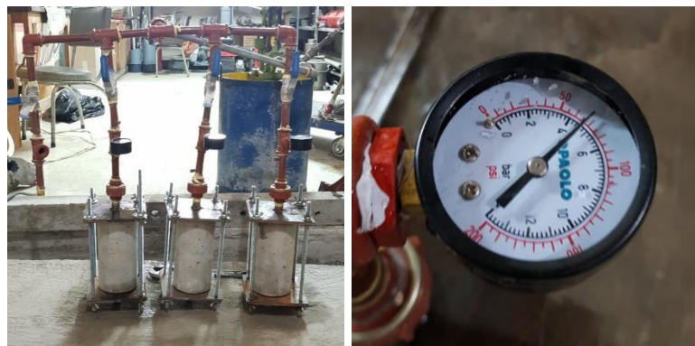
Figura 52 Inicio de ensayo de permeabilidad y control de la presión del agua
