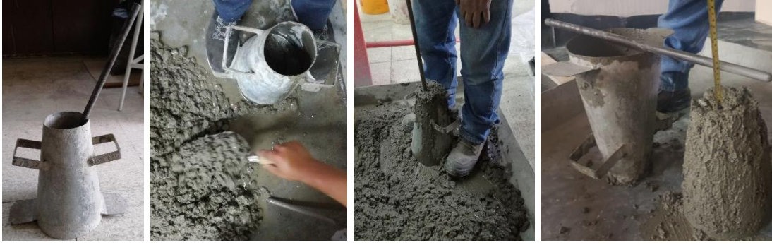
Figura 36 Ensayo de consistencia del hormigón fresco
