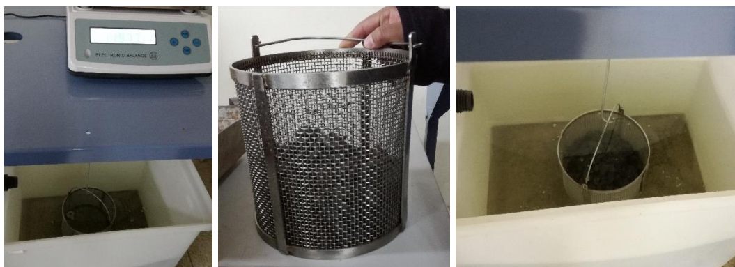
Figura 26 Toma de pesos de la canastilla y del agregado sumergido
