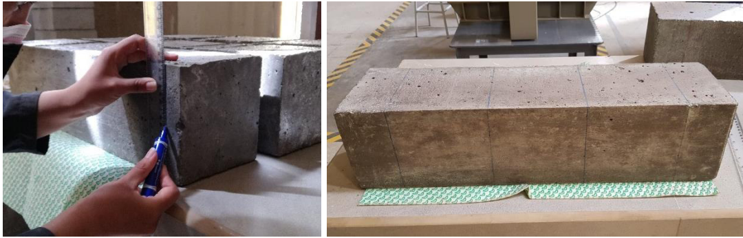
Figura 45 Preparación de la viga antes del ensayo
