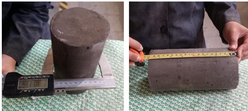
Figura 40 Toma de dimensiones de las probetas de hormigón
