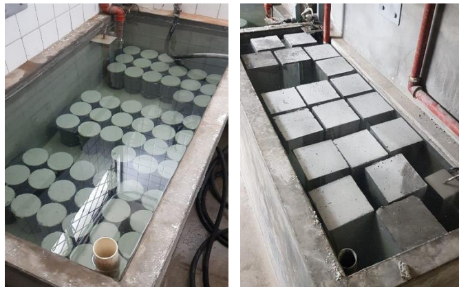
Figura 39 Curado de probetas de hormigón
