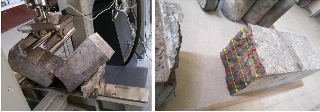
Figura 47 Ensayo de la probeta y toma de medidas luego de la falla
