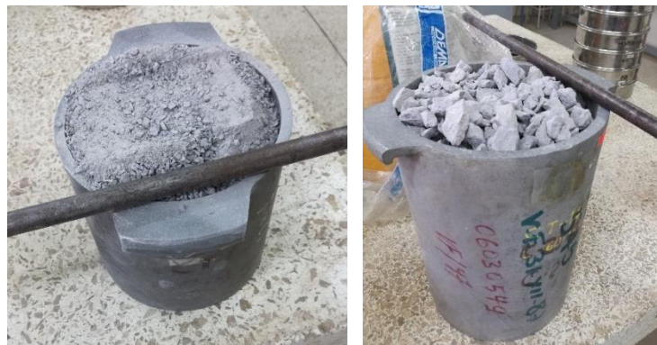
Figura 16 Densidad aparente del agregado fino y grueso
