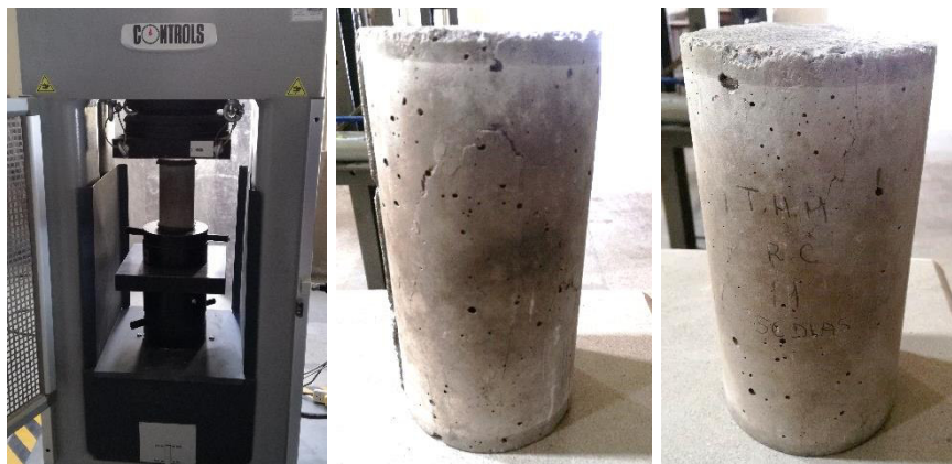
Figura 42 Ensayo a compresión de cilindros de hormigón
