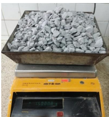
Figura 11 Muestra de agregado grueso para granulometría
