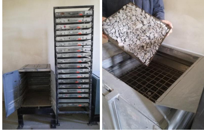
Figura 12 Selección de tamices y colocación de muestra para granulometría de agregado grueso
