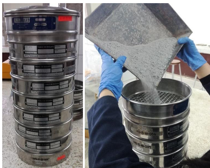
Figura 10 Serie de tamices para la granulometría del agregado fino
