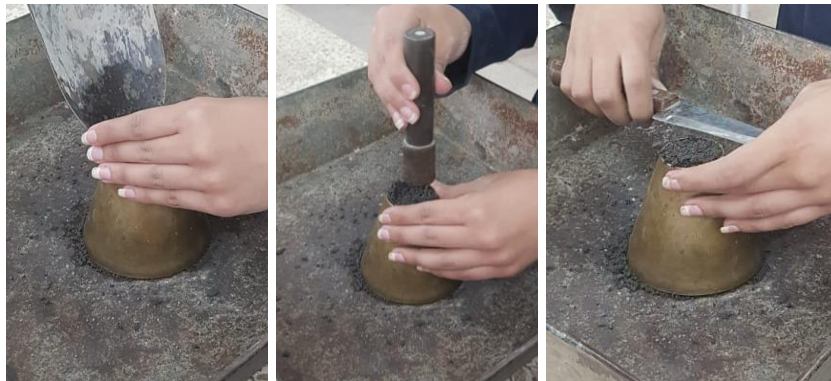
Figura 19 Colocación y compactación del material fino en el molde para determinar la condición SSS
