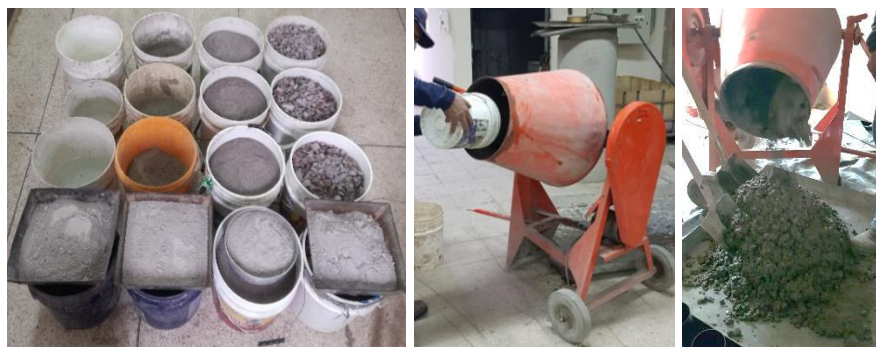
Figura 35 Elaboración de una tanda de hormigón
