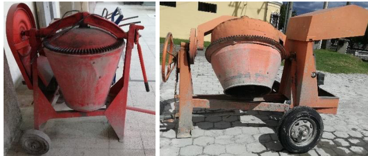
Figura 2 Concretetera de 12.5 Kg y 50 Kg de capacidad respectivamente
