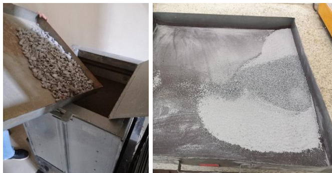
Figura 28 Pérdida durante el proceso de abrasión
