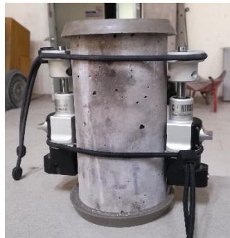
Figura 43 Colocación de extensómetros en el cilindro de hormigón
