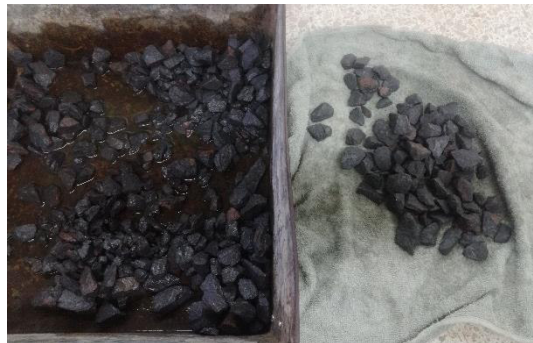
Figura 25 Condición SSS del agregado grueso
