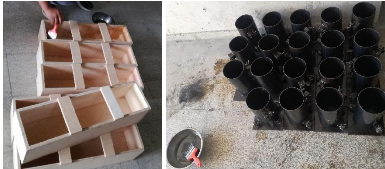
Figura 33 Encofrados para vigas y cilindros
