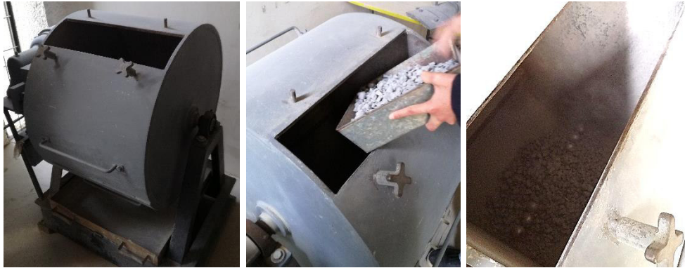
Figura 27 Colocación de agregado y esferas dentro de la Máquina de los Ángeles
