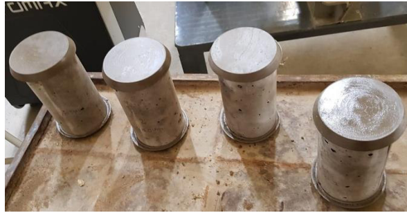
Figura 41 Refrentado de las caras de los cilindros
