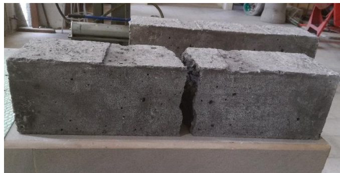
Figura 48 Verificación de la posición donde ocurre la falla
