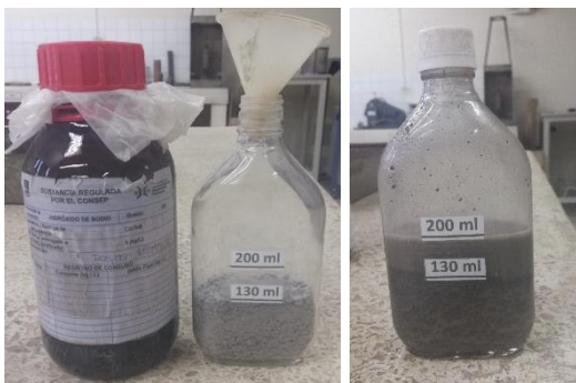
Figura 29 Ensayo de contenido orgánico de arena
