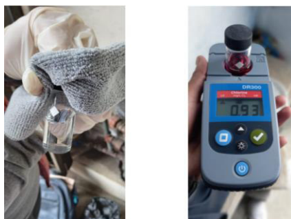
Figura 11. Análisis de agua del tanque de almacenamiento del Tambo 3.
