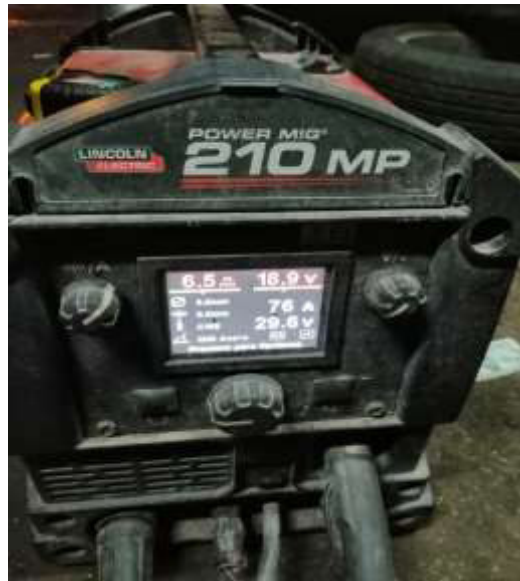
Figura 3.18 Valores colocados en la suelda MIG
