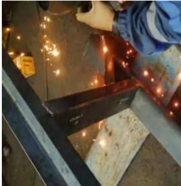
Figura 3.23 Unión de las estructuras de soporte diagonal para el molde hembra
