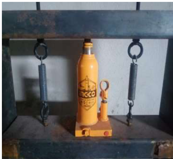
Figura 3.26 Inserción de la gata hidráulica en la estructura metálica
