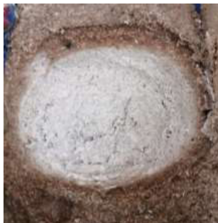
Figura 3.28 Matriz hembra elaborado de aserrín y cola
