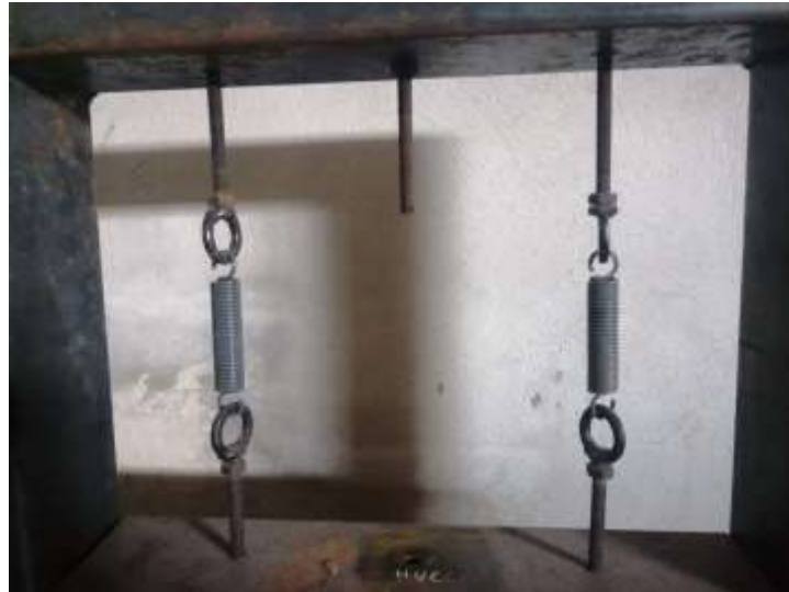
Figura 3.25 Unión de los resortes de tensión en los cáncamos
