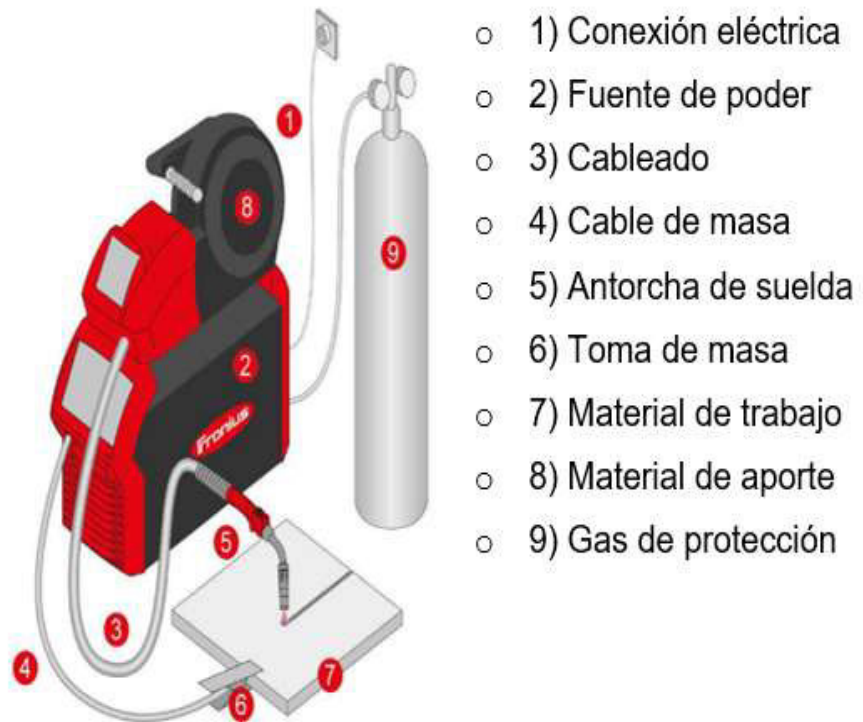
Figura 1.2 Partes de un proceso MIG/MAG [9]
