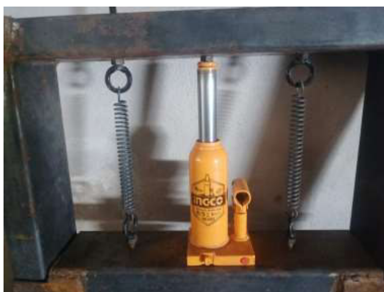
Figura 3.32 Extensión de los resortes y de la gata hidráulica
