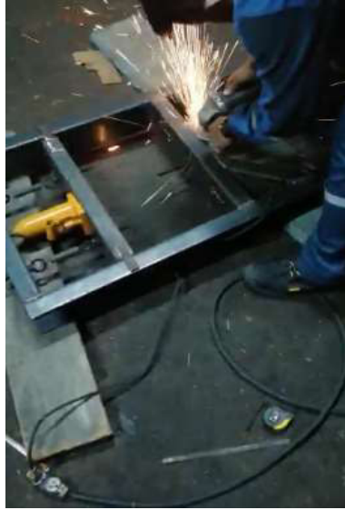
Figura 3.21 Unión de los pernos soldados para el soporte de la matriz hembra
