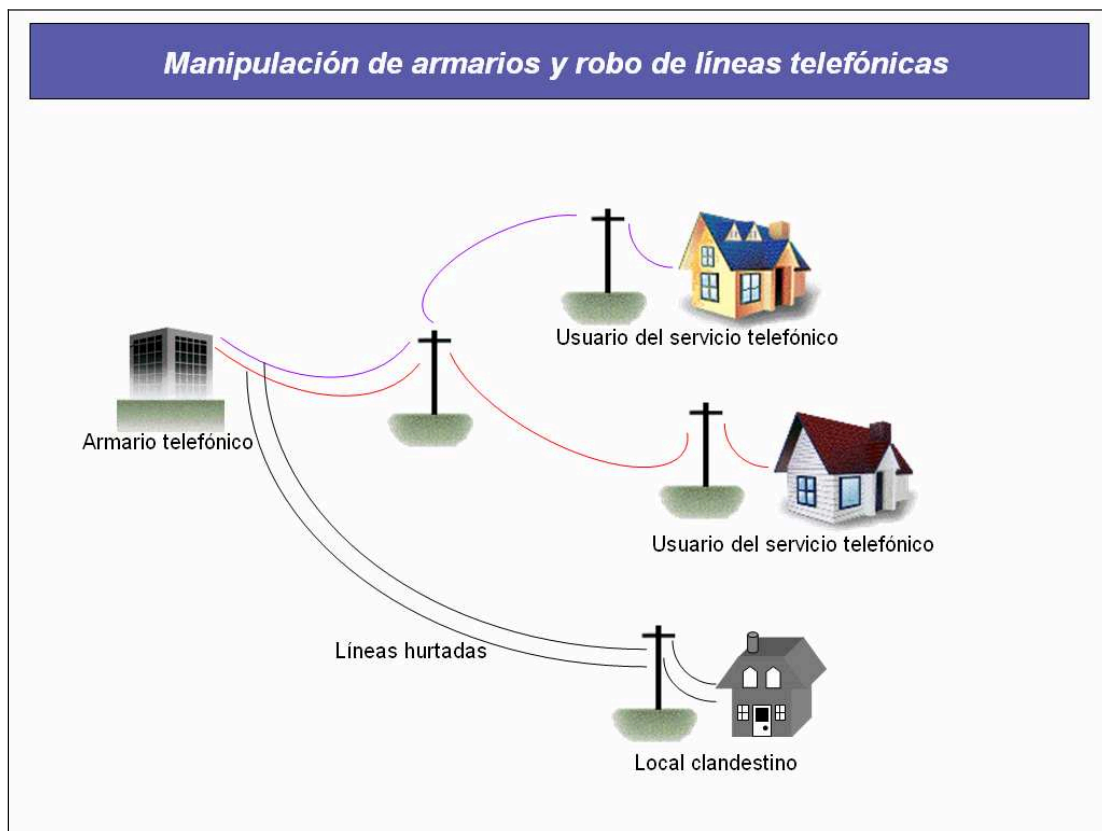
Figura 2.3. Manipulación de armarios y robo de líneas telefónicas
