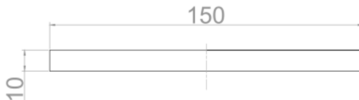
Figura 2.15 Dimensiones de las probetas para el ensayo de doblado. (Fuente: Propia)
