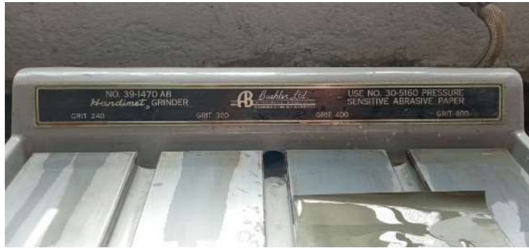
Figura 2.18. Máquina Handimet grinder para desbaste fino. (Fuente: Propia)
