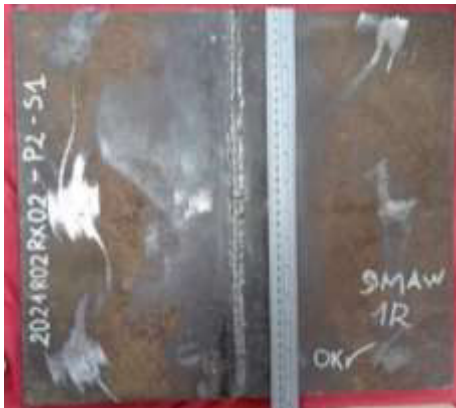
Figura 2.8 Placa preparada y limpia para el proceso de inspección visual. (Fuente: Propia)
