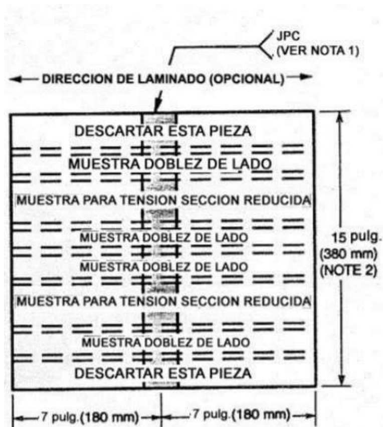
Figura 2.12. Recomendaciones de ubicación para la obtención de muestras por ensayo. (Fuente: [4])
