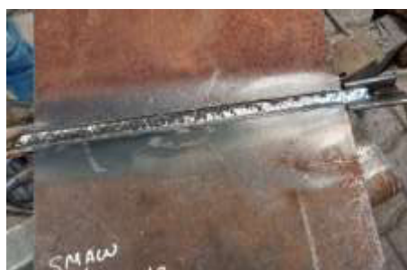
Figura 2.4. Junta soldada bajo el procedimiento “B”. (Fuente: Propia)
