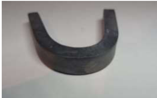
Figura 2.17 Disposición final de la probeta después del ensayo de doblado (Fuente: Propia)
