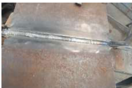
Figura 2.3. Junta soldada bajo el procedimiento “A”. (Fuente: Propia)
