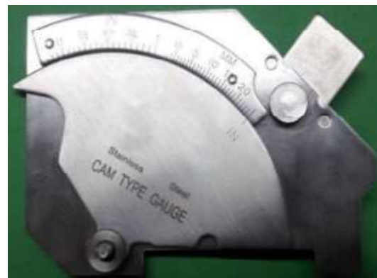
Figura 2.9 Galga Bridge para la medición de discontinuidades en el cordón. (Fuente: Propia)
