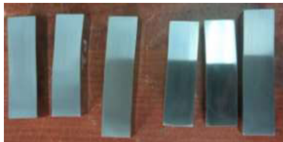
Figura 2.19. Probetas post proceso de preparación y pulido. (Fuente: Propia)
