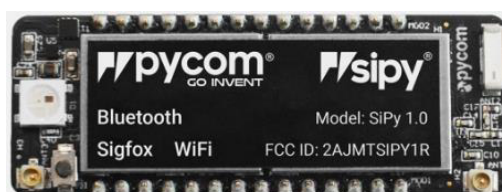
Figura 1.8 Nodo Pycom SiPy [11].
