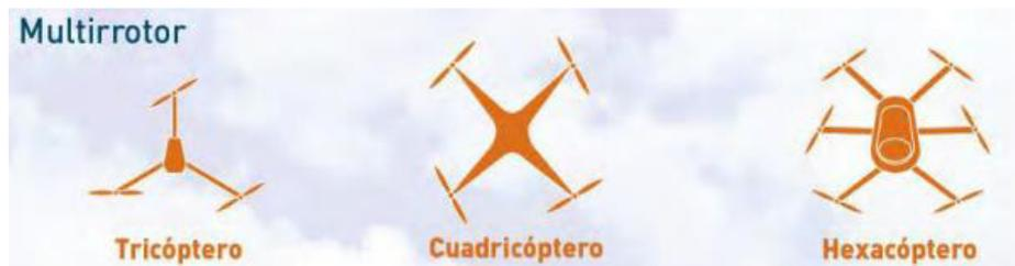
**Figura 1.1.** Aeronaves multirrotores [12].
