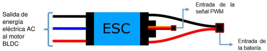
**Figura 1.13.** Diagrama de un ESC.
