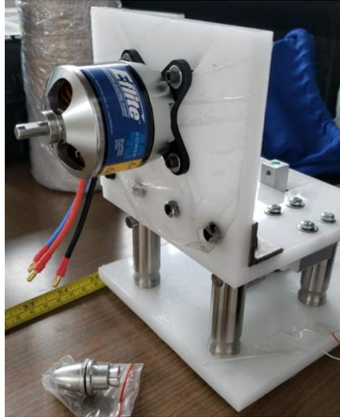
**Figura 2.9.** Montaje del motor sobre la base.
