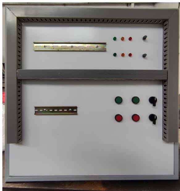
**Figura 2.41.** Estructura del tablero de control.
