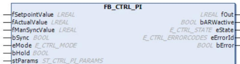
**Figura 2.76.** Bloque de función del controlador PI.
