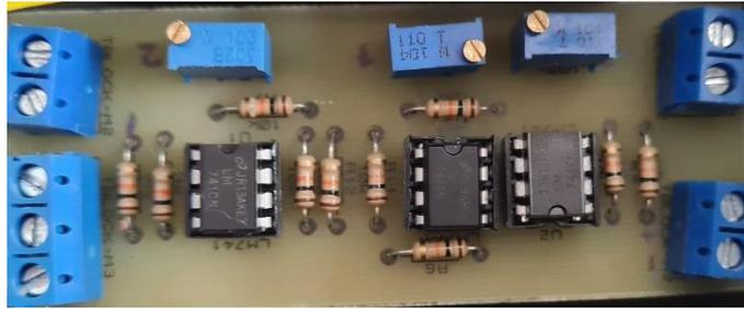
**Figura 2.31.** Placa de amplificación del sensor de corriente.
