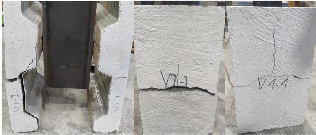
Figura 105. Modo de falla experimental del modelo VV-45
