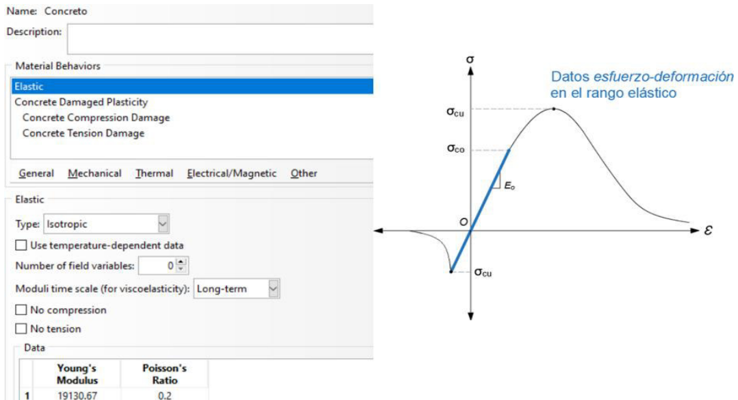
Figura 52. Definición del comportamiento elástico del concreto
