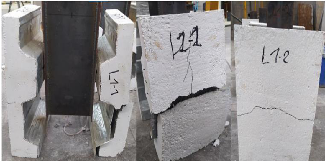
Figura 100. Modo de falla experimental del modelo VV-90
