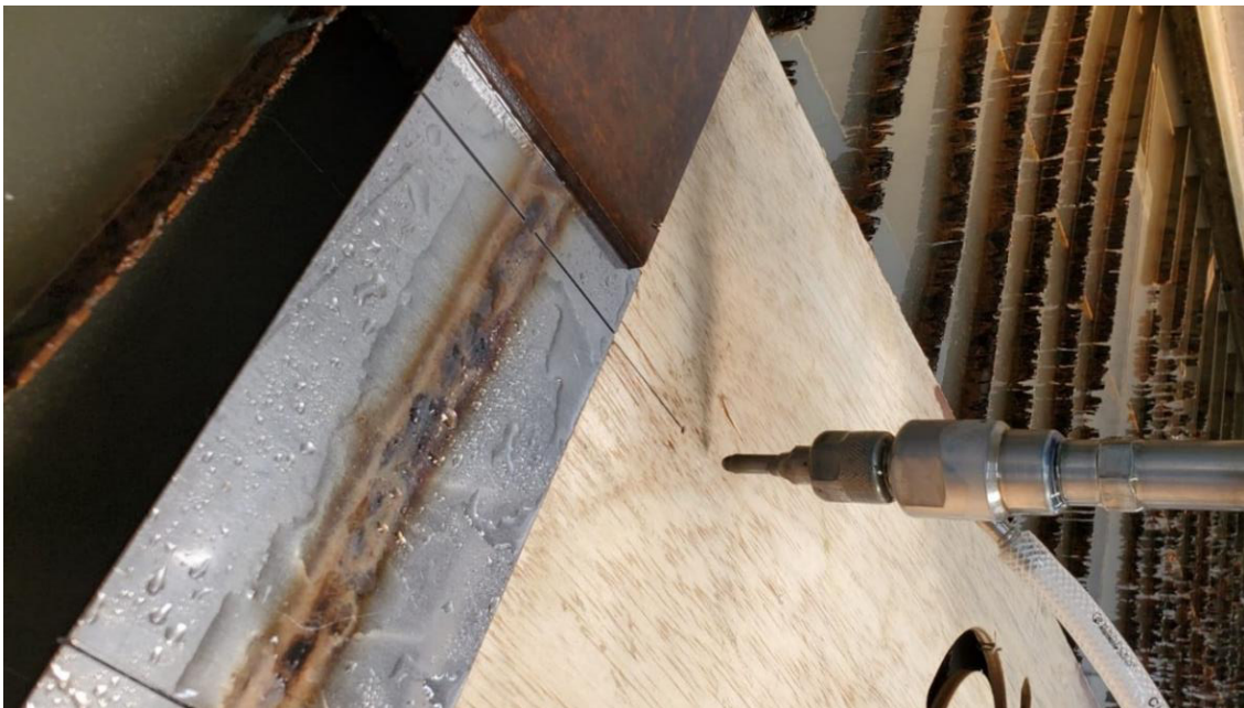
Fig. 2.9 Extracción de probeta por chorro de agua.
