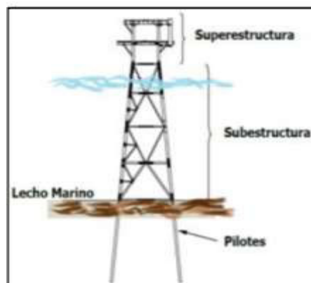
Figura 1.1 Estructura típica de una plataforma petrolera. (Fuente: Noriega, 2014)
