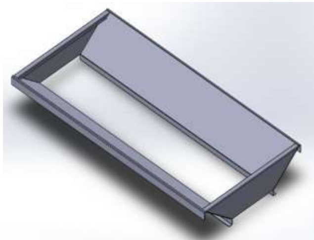
Figura 2.15. Tolva de ingreso. Fuente: [Propia]
