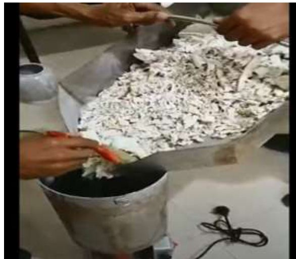
Figura 1.3. Colocación de restos incinerados en un molino eléctrico. Fuente: [4]
