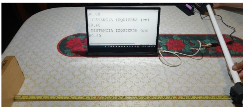
Figura 3.1. Prueba de medición al sensor izquierdo
