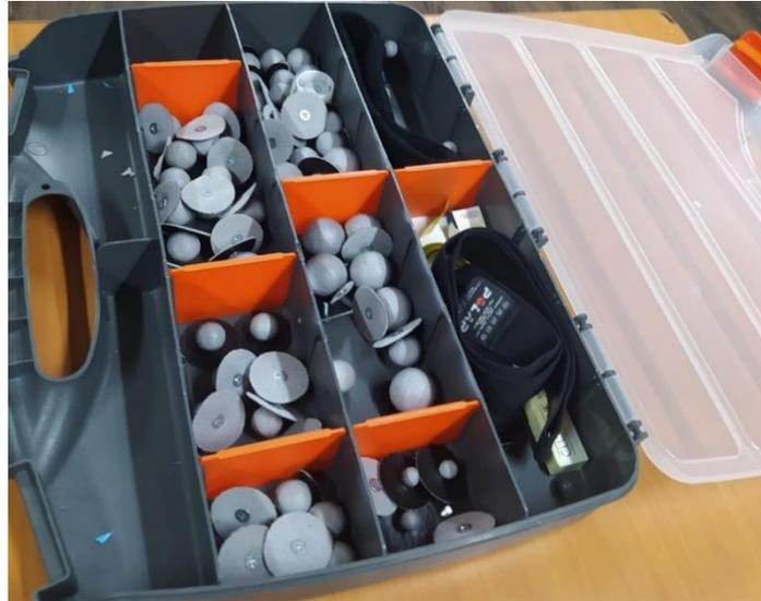
Figura 1.4. Marcadores y herramientas de calibración de Kinescan. (Fuente: Propia)
