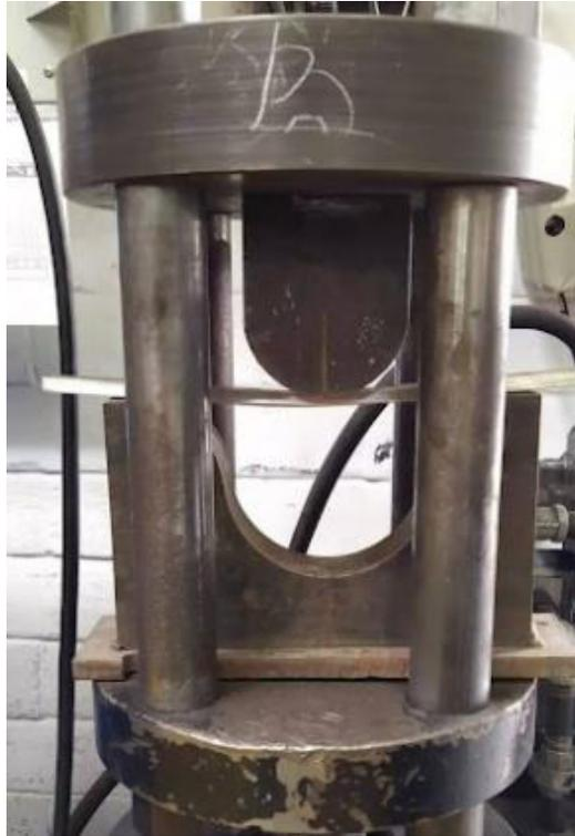
Figura 2.14. Esquema de la disposición de la probeta para ensayo de cara.
