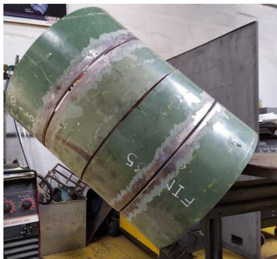
Figura 2.7. Secciones de tubería preparadas, alineadas, limpias y listas para el proceso de soldadura en posición 6G.
