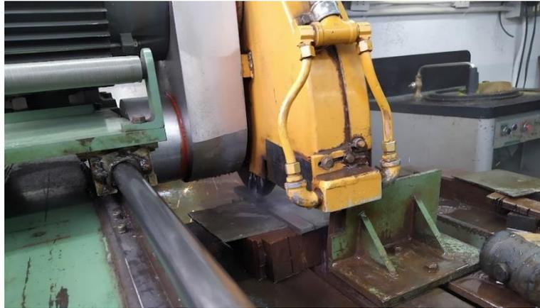
Figura 2.9. Máquina de corte refrigerado por agua.
