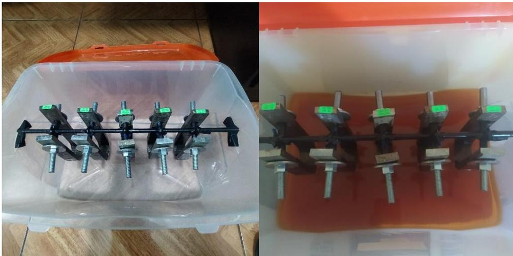
Figura 2.18. Disposición de las probetas para ensayo de corrosión.
