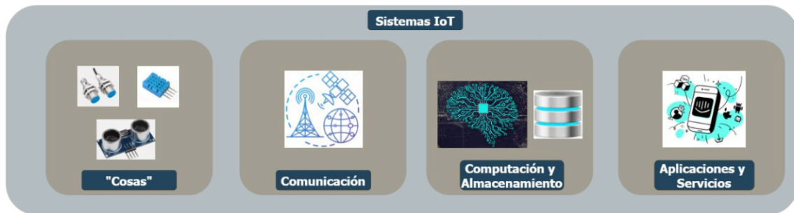
Figura 1.1. Diagrama de bloques de un sistema IoT basado en [7]
