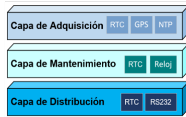
Figura 2.2. Arquitectura para la sincronización de reloj basada en [30]
