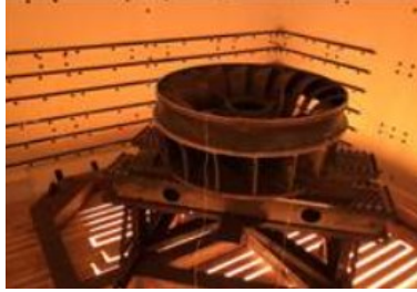
Figura 7 Tratamiento térmico posterior a la soldadura del rodete. (Fuente: [9])
