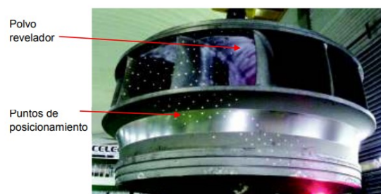
Figura 10 Rodete de Turbina Francis preparado para el escaneo 3D (Fuente: CIRT)
