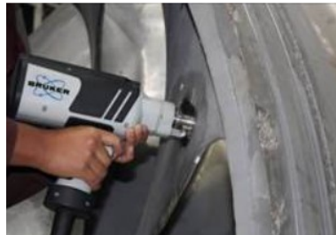
Figura 3 Espectrometría aplicada en la superficie del alabe (Fuente: [9])
