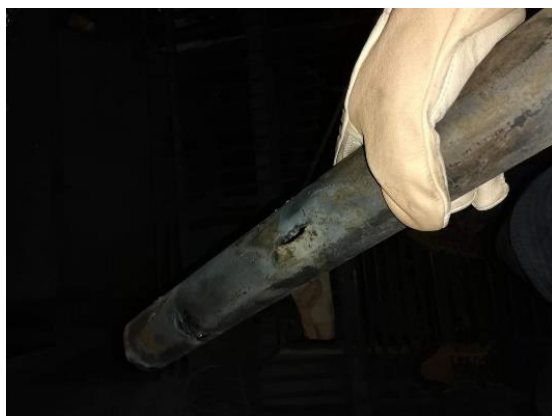
Figura 11. (a) Falla por abrasión (b) Válvula de seguridad domo superior. (Fuente: Propia)
