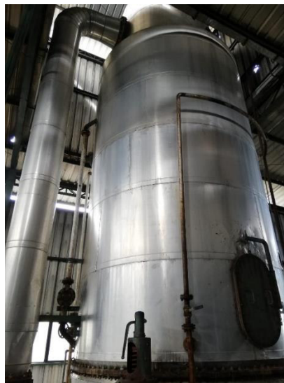
Figura 10. Pre-evaporador (Fuente: Propia).
