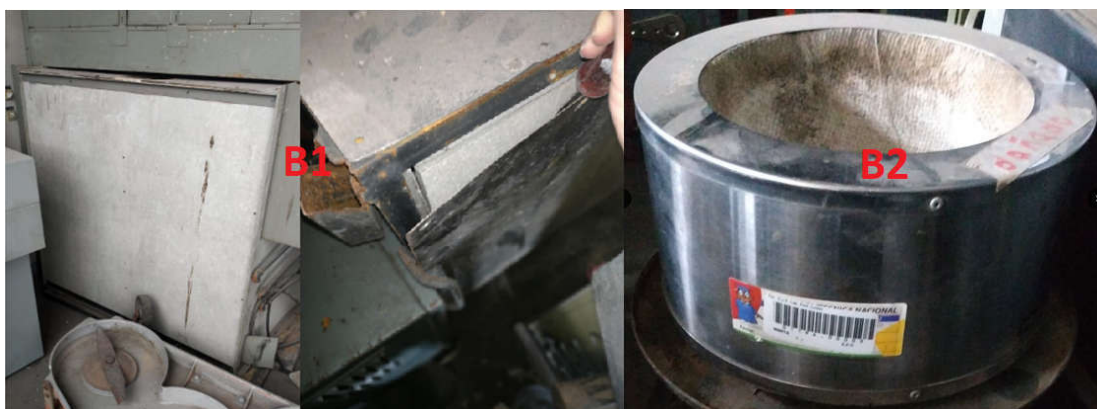
Figura N°6. Objetos con fibras encontrados en la bodega 1 y 2. En la bodega 1, láminas aislantes de la Sorbona y el horno mufla. La bodega 2, manta (tela) de calentamiento.
