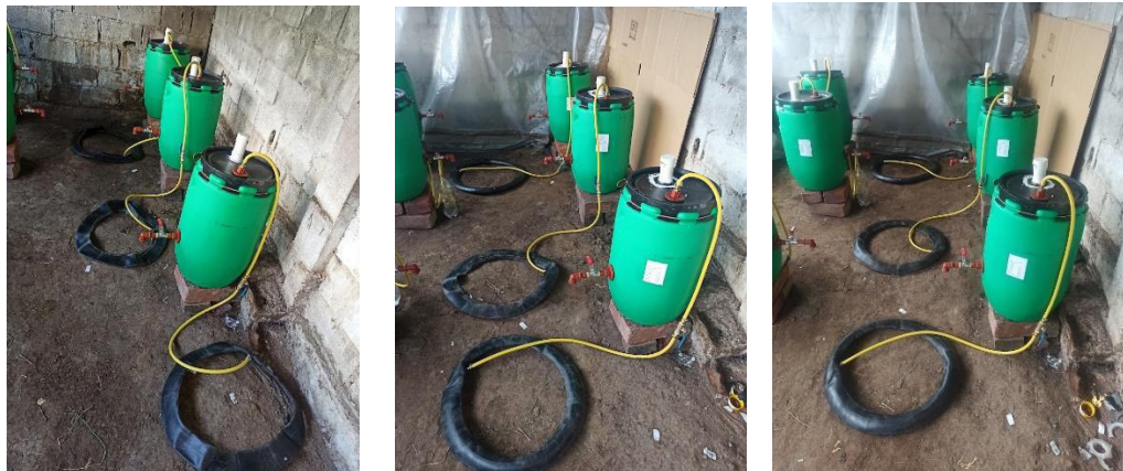
Fotografía 2.2.4.1. Inflado de boyas al inicio, a 13 días, a 20 días de la instalación respectivamente.
