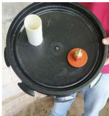
Fotografía 2.2.1.5 Instalación de tubo de monitoreo y salida de gas
