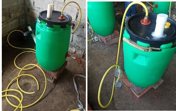
Fotografía 2.2.1.6 Instalación de mangueras para biol
