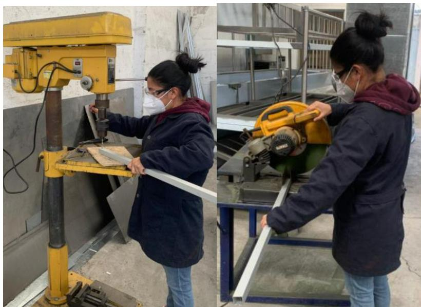
**Figura 2.7.** Proceso de perforación y corte de tubos
