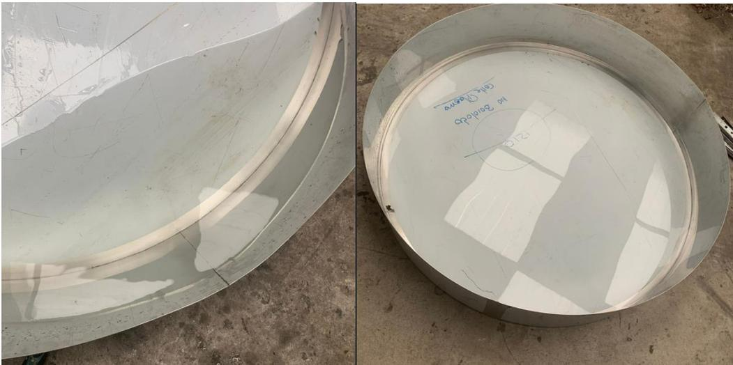
**Figura 3.5.** tanque con agua, comprobación de fallas
