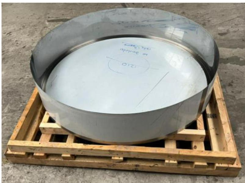
**Figura 3.2.** Tanque evaporimétrico construido
