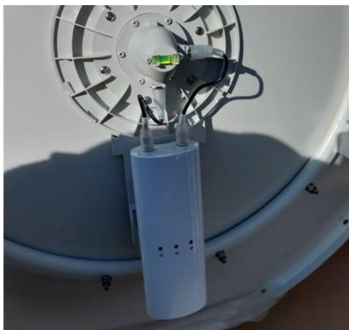
Figura 3.27 Colocación de radio Mimosa C5c
