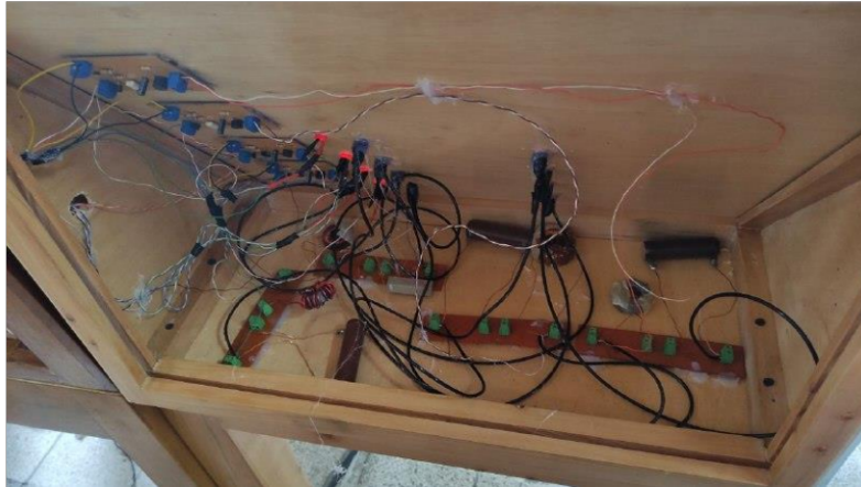
Figura 2.21. Implementación de placas y cableado al módulo de impedancia.
