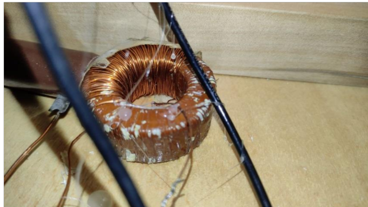
Figura 13. Inductancia construida en base a un núcleo toroidal.
