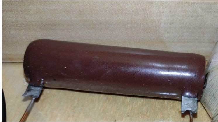
Figura 12. Resistencia implementada en el módulo del alimentador primario.
