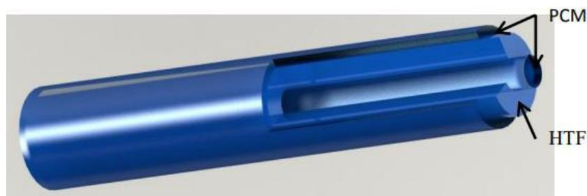
**Figura 1.4.** Secciones del intercambiador multitubular
