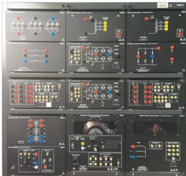
**Figura 24.** Sistema Festo para la simulación de generación eólica
