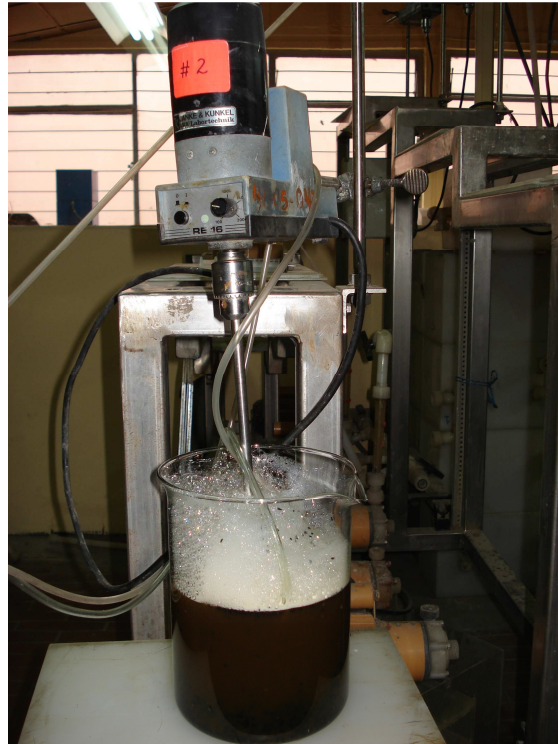
Figura 3.7. Tratamiento de efluente de aireación en presencia de carbón activado en el reactor de capacidad 1,2 L
