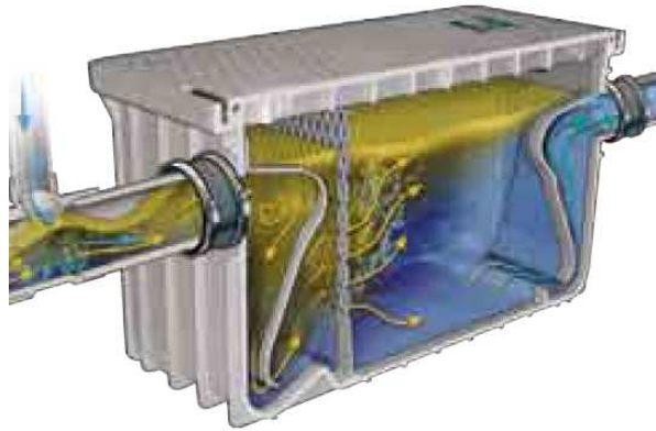
Figura 1.5 Esquema de una trampa de grasa (Sainz, 2004)
