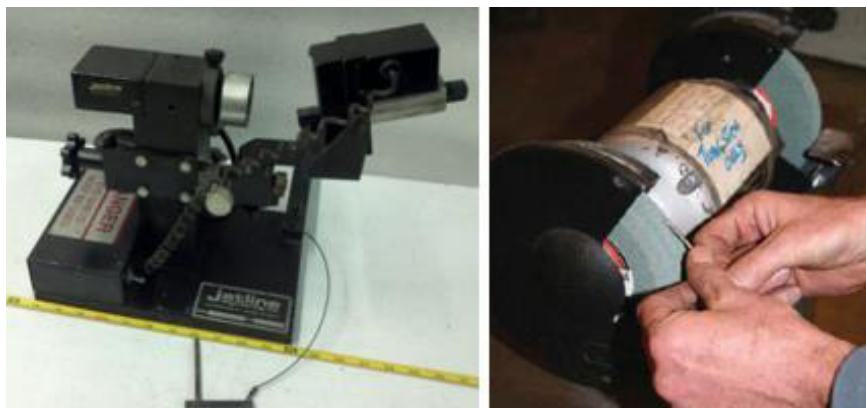
Figura 1.12. Máquina para esmerilar la punta del electrodo de tungsteno (izq.) y esmeril simple (derecha). [14] y [5].
