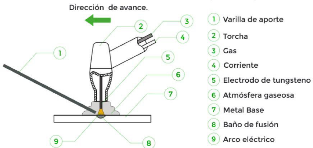
Figura 1.2. Proceso de soldadura GTAW. [8]
