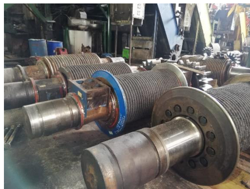
Figura 4. Cilindros ranurados (masas) (Fuente: Propia).
