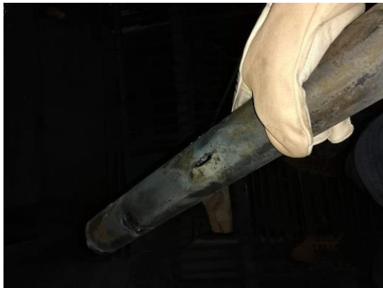
Figura 19. (a) Falla por abrasión (b) Válvula de seguridad domo superior. (Fuente: Propia)
