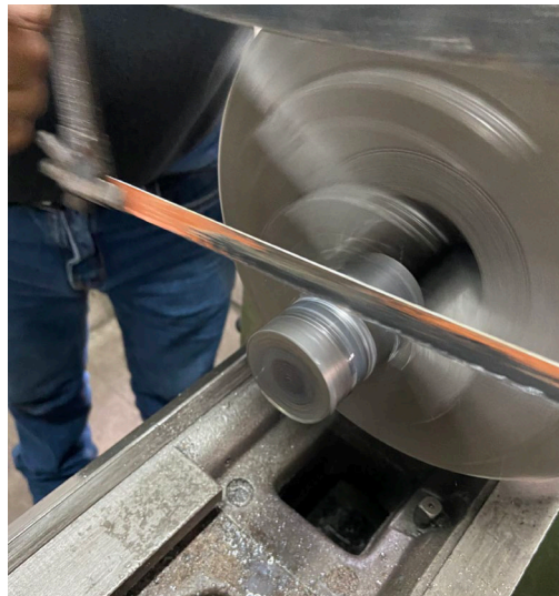
Figura 14 Extracción de parte media del cilindro (Fuente propia)
