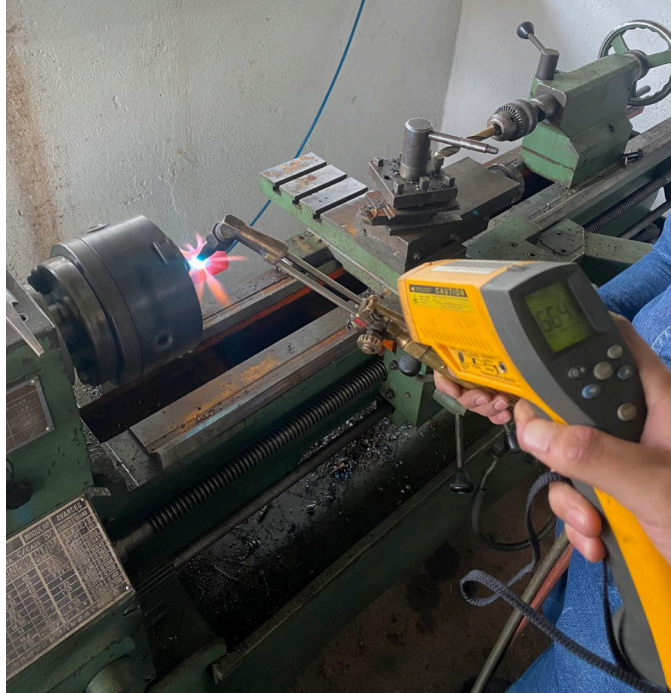
Figura 12 Control de temperatura (Fuente propia)
