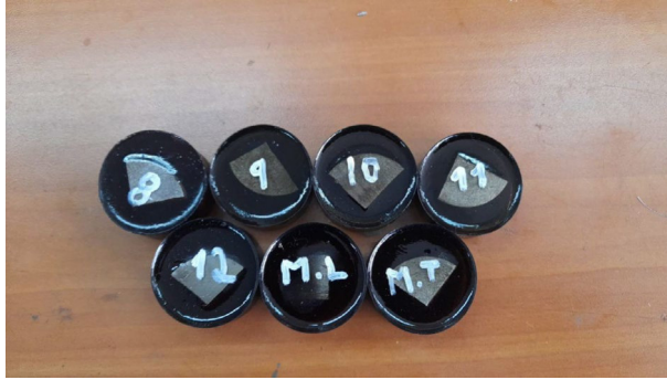
Figura 19 Muestras montadas en resina (Fuente propia)
