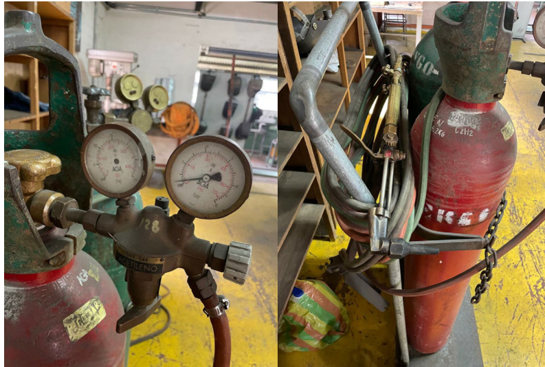
Figura 2. Equipos utilizados para OAW (Fuente propia)
