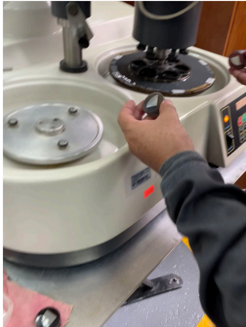
Figura 20 Proceso de desbaste en máquina. (Fuente propia)
