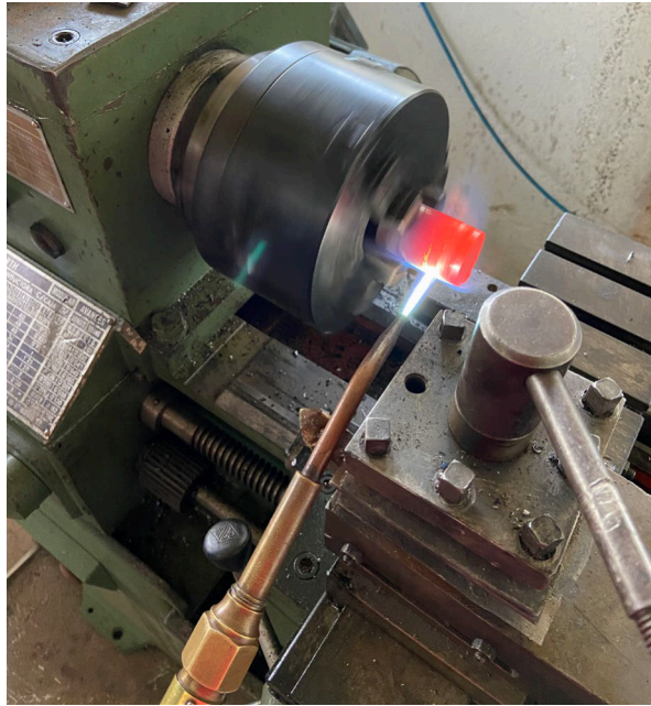
Figura 11 Aplicación de llama carburante (Fuente propia)
