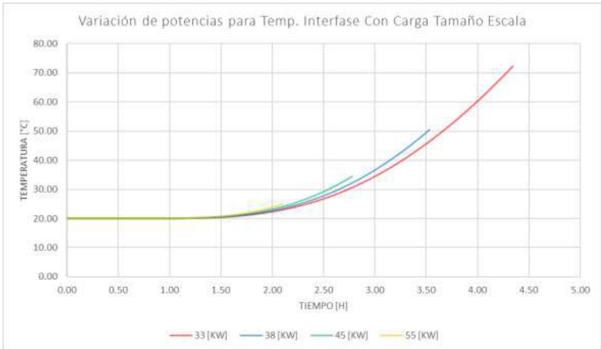
Figura 8. Variación de potencias para la temperatura de la interfase a tamaño escala con carga con lana de vidrio [Fuente: Propia].
