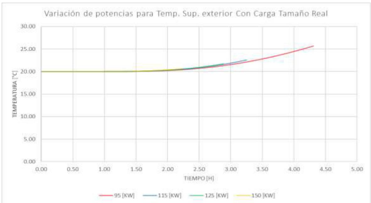
Figura 21. Variación de potencias para la temperatura superficial exterior a tamaño real con carga de lana de vidrio [Fuente: Propia].
