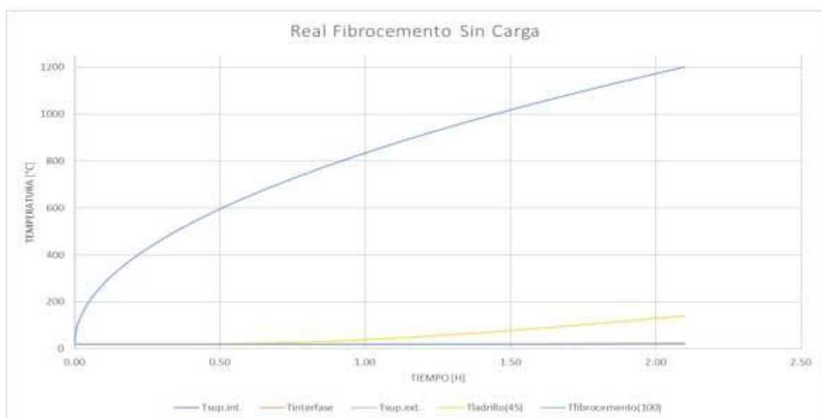
Figura 22. Distribución de temperatura con fibrocemento [Fuente: Propia].
