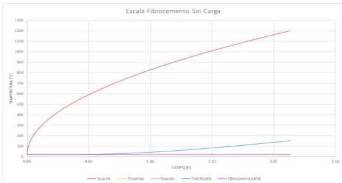
Figura 10. Distribución de temperatura con fibrocemento a tamaño escala sin carga [Fuente: Propia].
