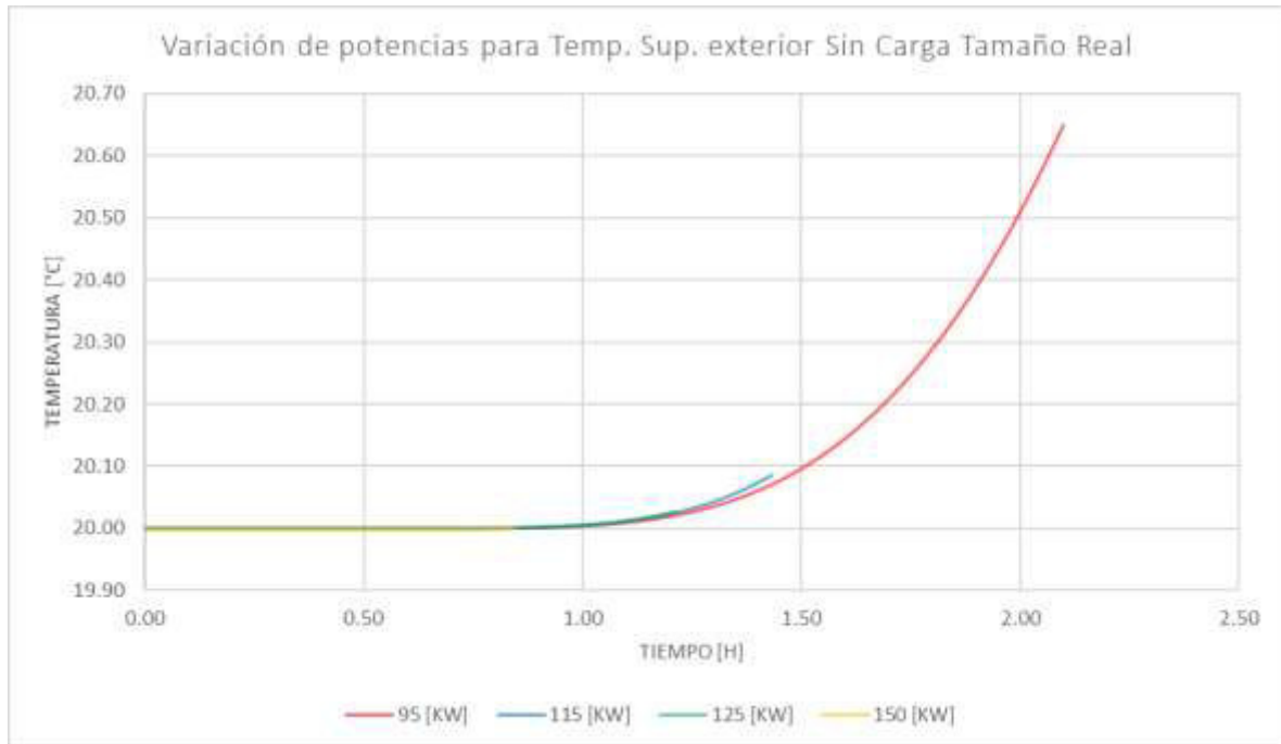
Figura 26. Variación de potencias para la temperatura superficial exterior [Fuente: Propia].
