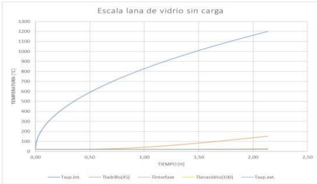
Figura 11. Distribución de temperatura con lana de vidrio a tamaño escala sin carga [Fuente: Propia].
