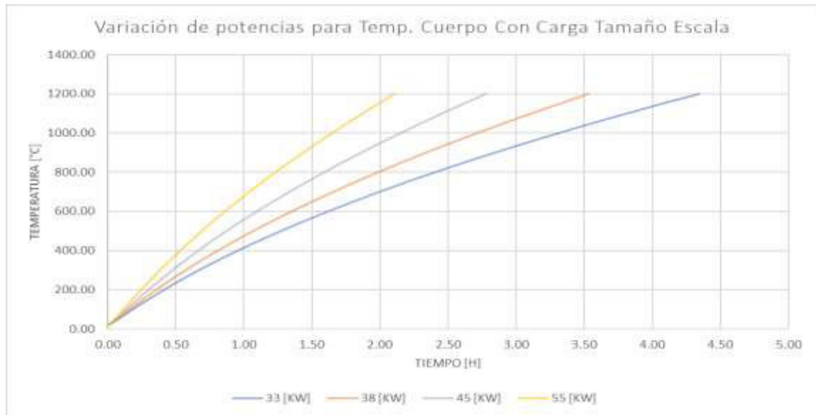
Figura 7. Variación de potencias para la temperatura del cuerpo a tamaño escala con carga de lana de vidrio [Fuente: Propia].
