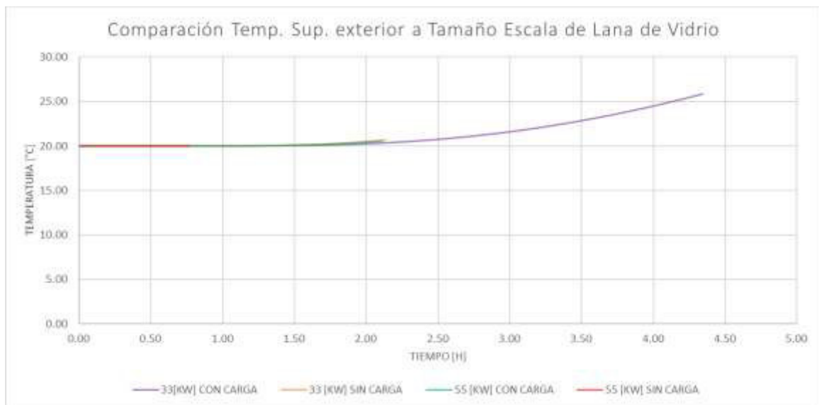
Figura 16. Temperatura superficial exterior para el modelo a escala de lana de vidrio con carga y sin carga [Fuente: Propia].
