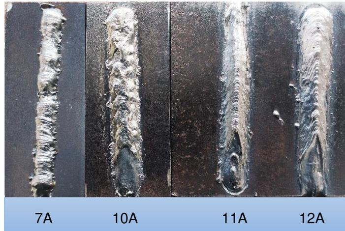
**Figura 2.7.** Cordones de soldadura: velocidad de alimentación y velocidad de avance constante, stick out 10 mm, ángulo de boquilla 90°.
