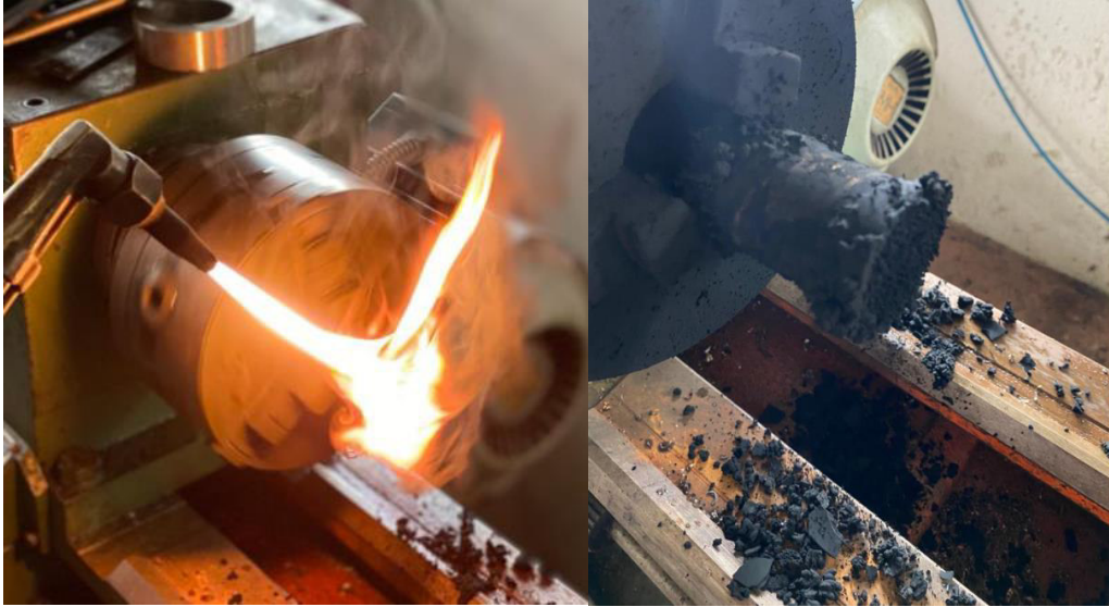
Figura 13 Llama completamente carburante y hollín en la probeta P-02. (Fuente propia)
