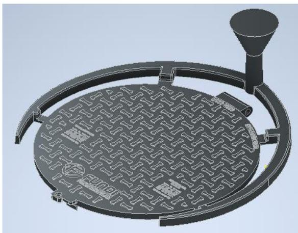
**Figura 3.9** CAD Sistema de alimentación final (Fuente propia)
