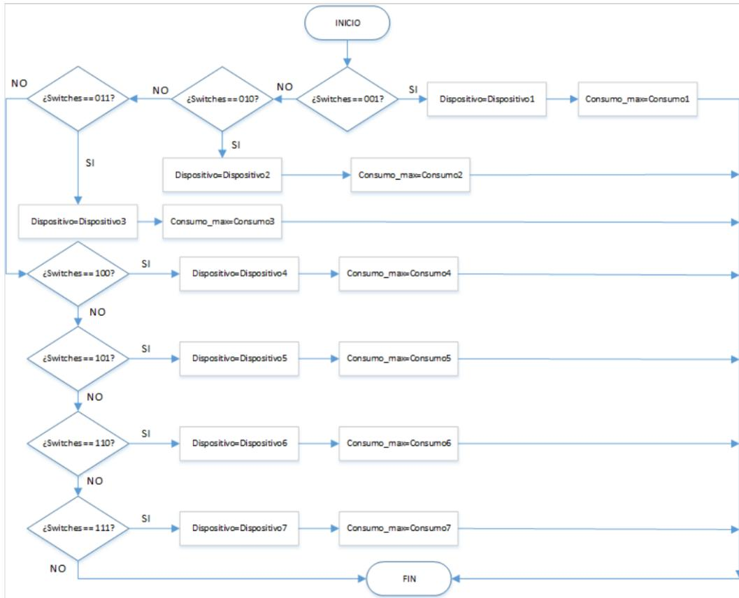
Figura 2.18 Diagrama de flujo para la rutina de identificador de dispositivo
