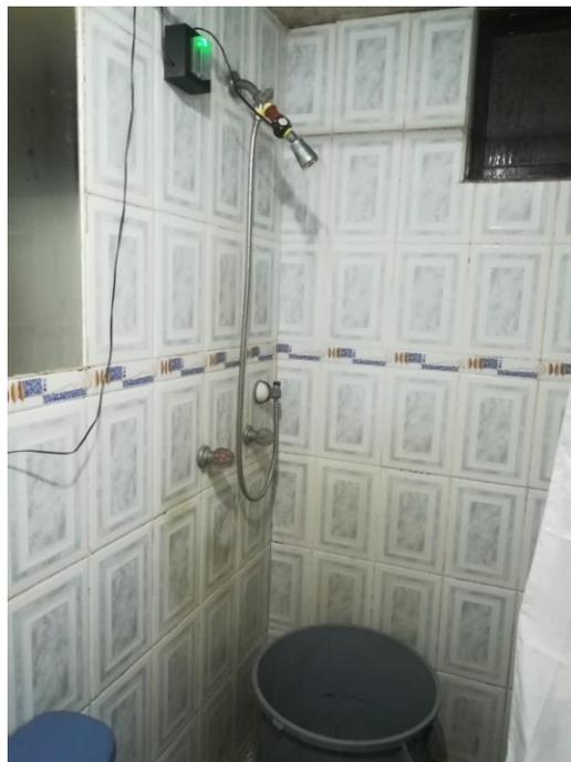
**Figura 3.13** Llenado de recipiente de 50 litros para validación de medidas
