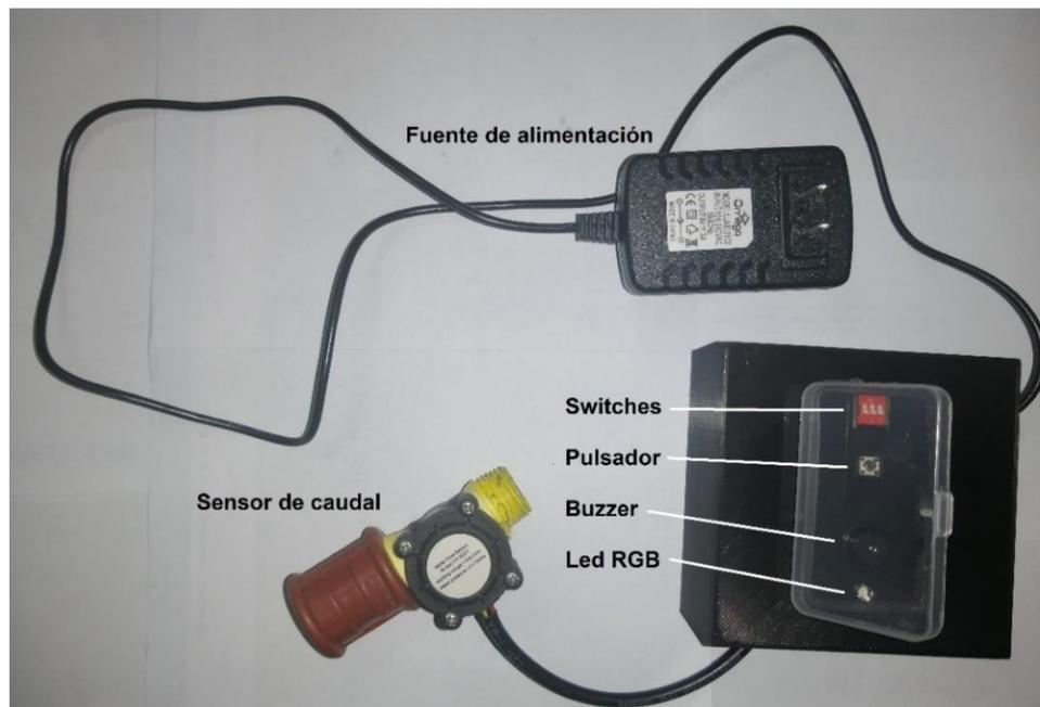
**Figura 2.5** Estructura física implementada
