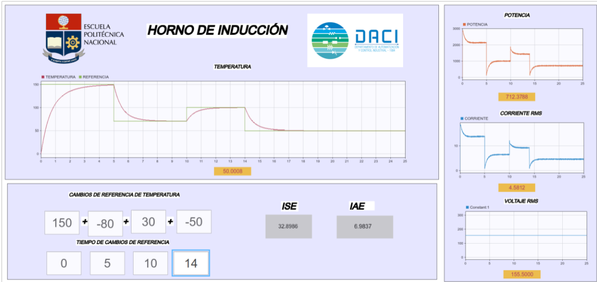
Figura 52. Interfaz gráfica para el usuario con cambios de referencia con corrección de anti-windup simulado en Simulink
