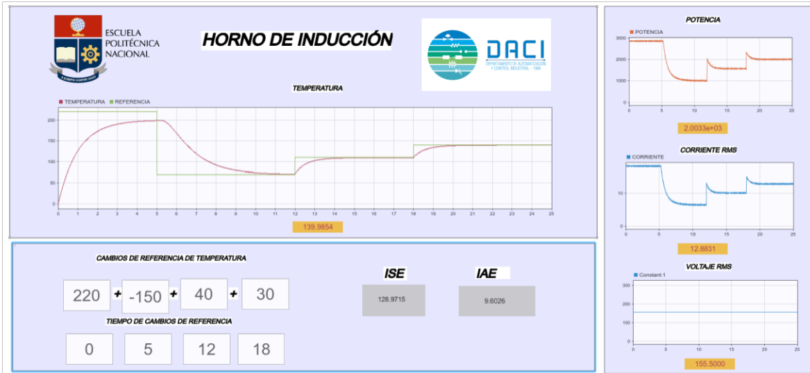
Figura 50. Interfaz gráfica para el usuario con cambios de referencia sin corregir anti-windup simulado en Simulink
