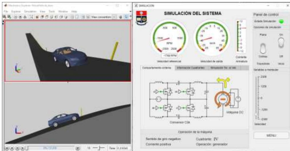
Figura 3.14 Simulación del sistema en el cuarto cuadrante.
