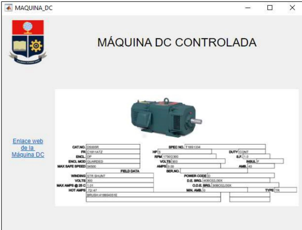
**Figura A1.2** Ventana de datos técnicos de la máquina DC.
