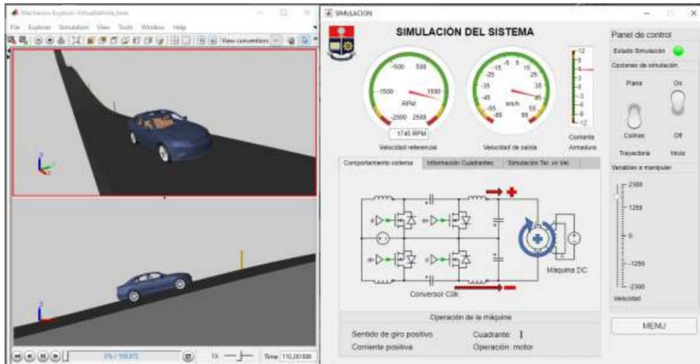
Figura 3.11 Simulación del sistema en el primer cuadrante.
